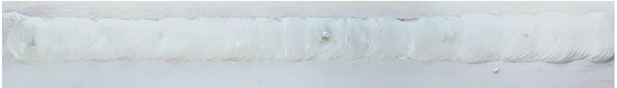
Slika 75. Uzorak B s nanesenim razvijačem - lice zavora
