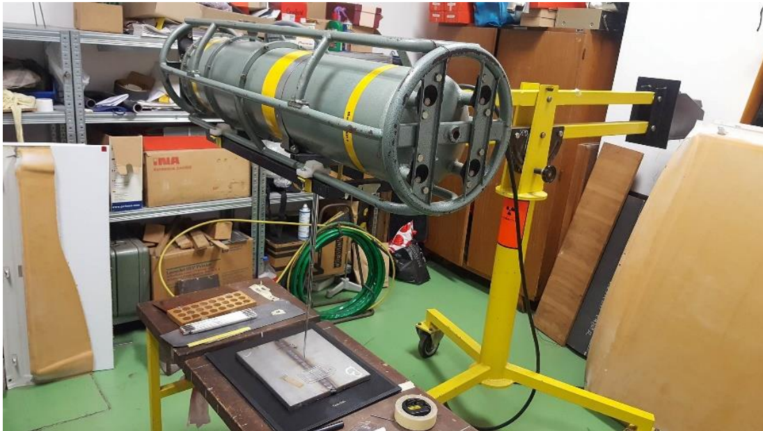
Slika 48. Uzorak pripremljen za radiografsko ispitivanje
