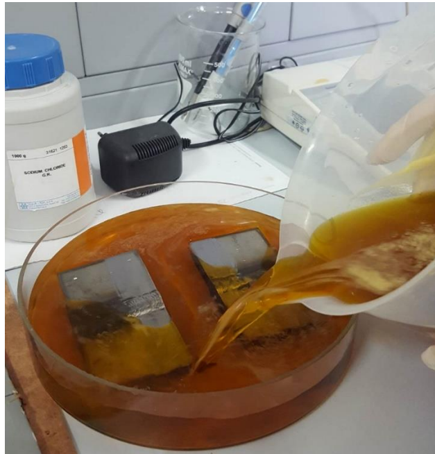
Slika 67. Prikaz ulijevanja ispitne otopine - početak ispitivanja
