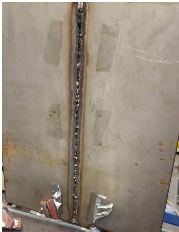
Slika 40. Izgled korijena zavora uzorka A
