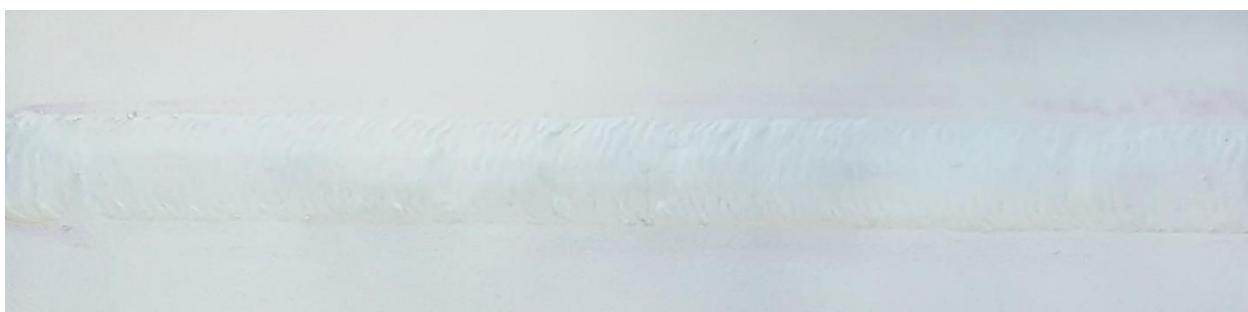
Slika 73. Uzorak A s nanesenim razvijačem - lice zavara
