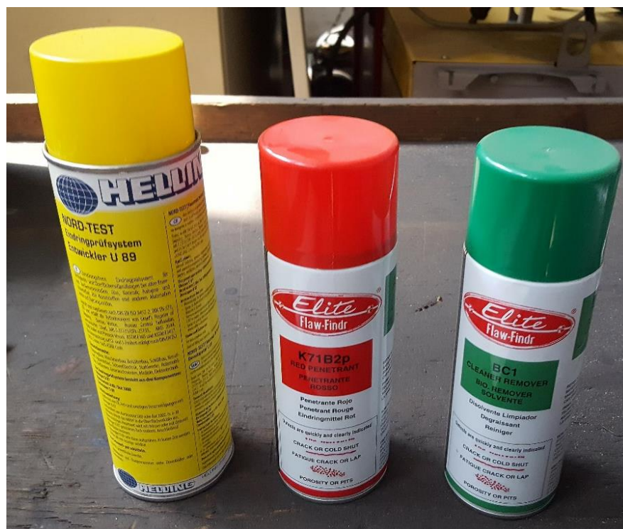
Slika 49. Razvijач, penetrant i čistač korišteni u postupku
