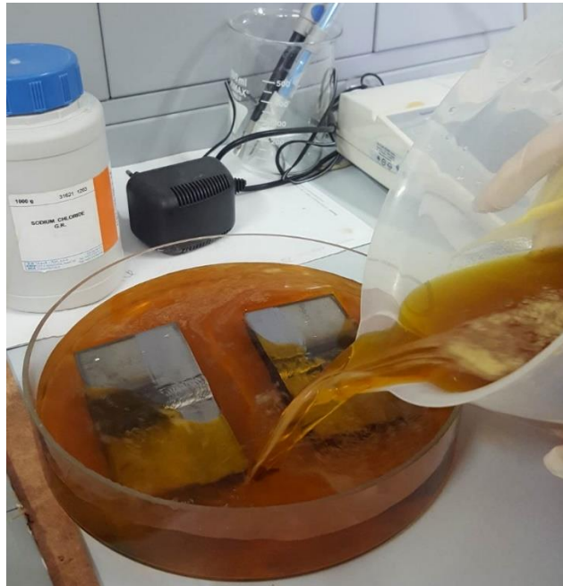
Slika 67. Prikaz ulijevanja ispitne otopine - početak ispitivanja
