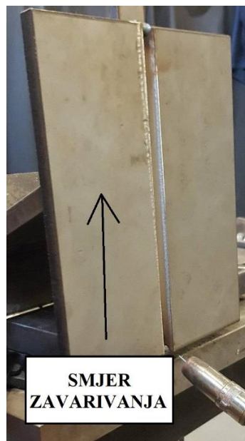
Slika 38. Položaj i smjer zavarivanja
