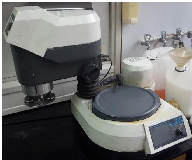
Slika 56. Uređaj za brušenje BUEHLER PHOENIX ALPHA
