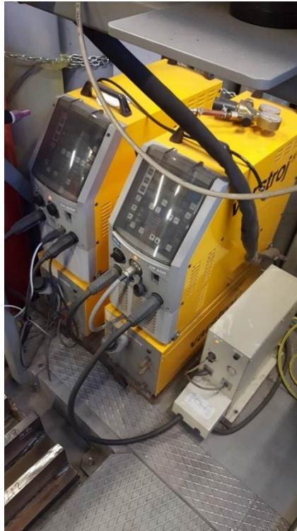
Slika 32. Izvor struje OTC Daihen Varstroj DP400
