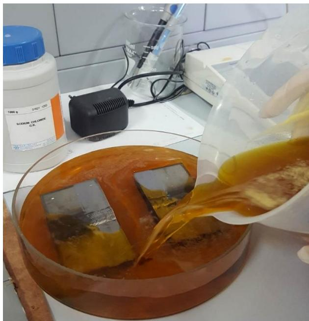
Slika 67. Prikaz ulijevanja ispitne otopine - početak ispitivanja
