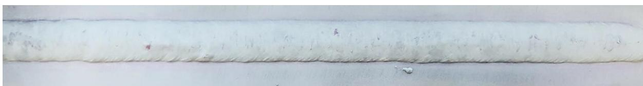
Slika 76. Uzorak B s nanesenim razvijačem - korijen zavara
