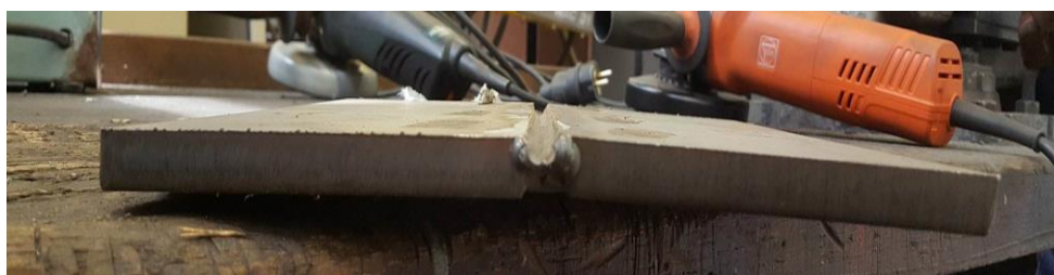
Slika 43. Izbrušen korijen zavora - uzorak A
