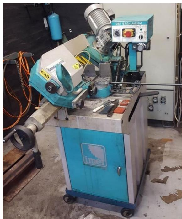
Slika 55. Rezanje uzorka na tračnoj pili
