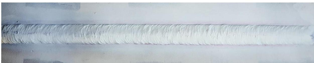
Slika 74. Uzorak A s nanesenim razvijačem - korijen zavara
