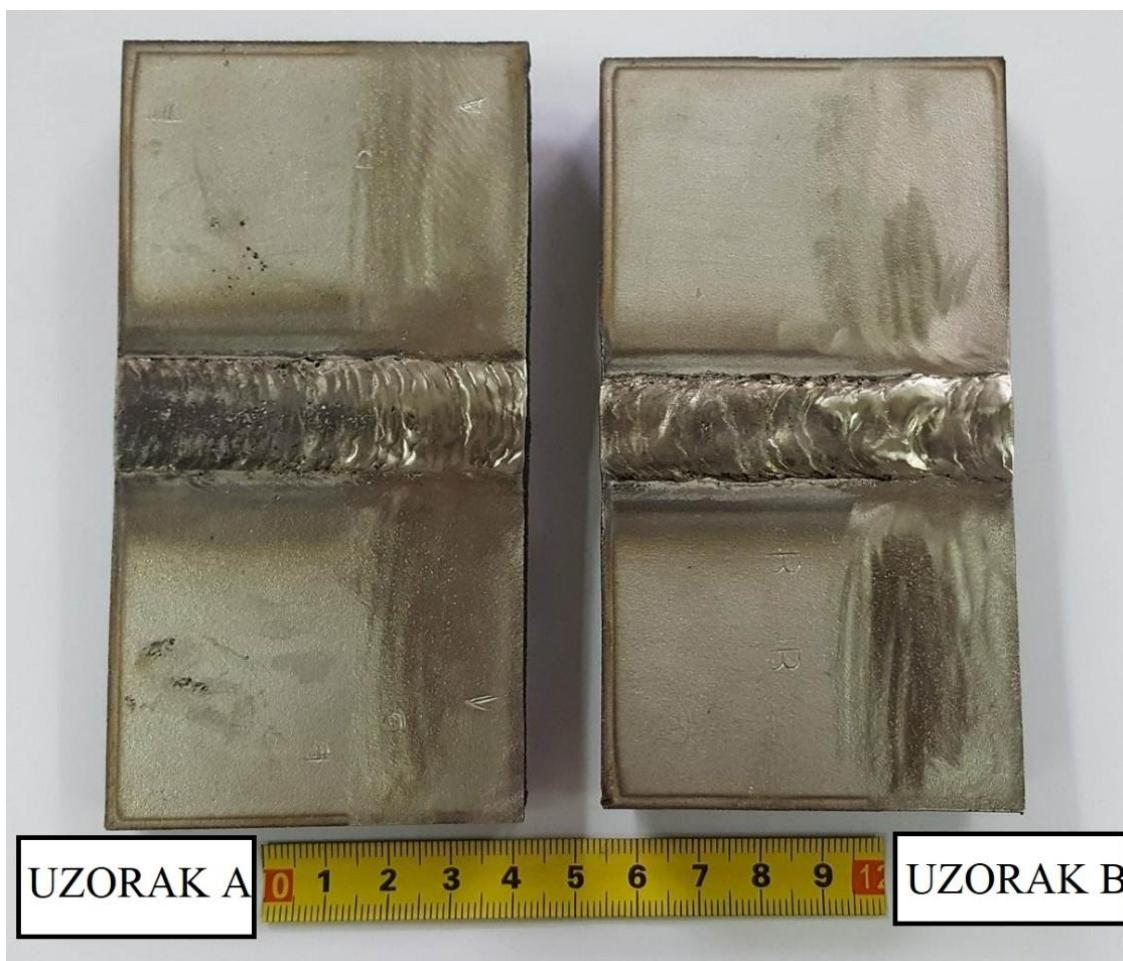
Slika 89. Izgled ispitnih uzoraka nakon izlaganja agresivnoj otopini
