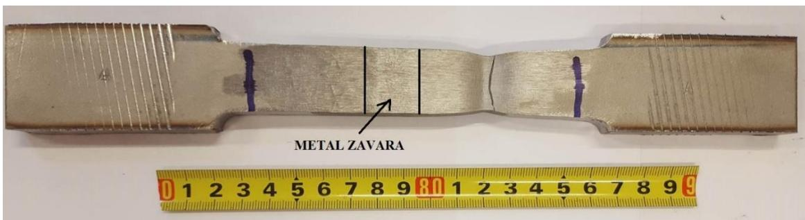
Slika 84. Uzorak A nakon statičkog vlačnog ispitivanja
