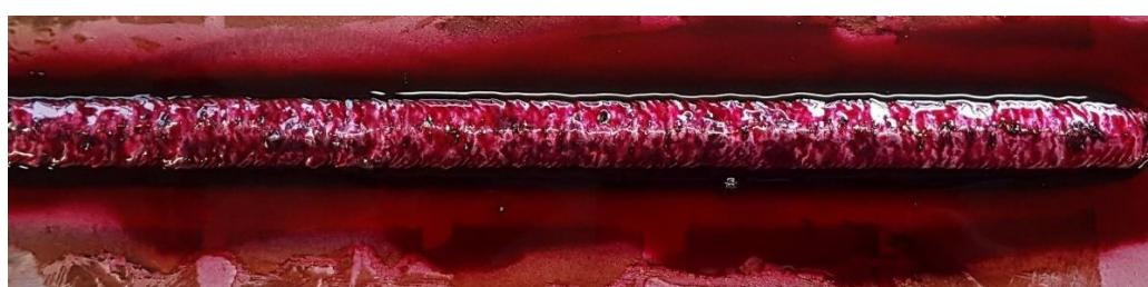
Slika 53. Uzorak B s nanesenim penetrantom - korijen zavara
