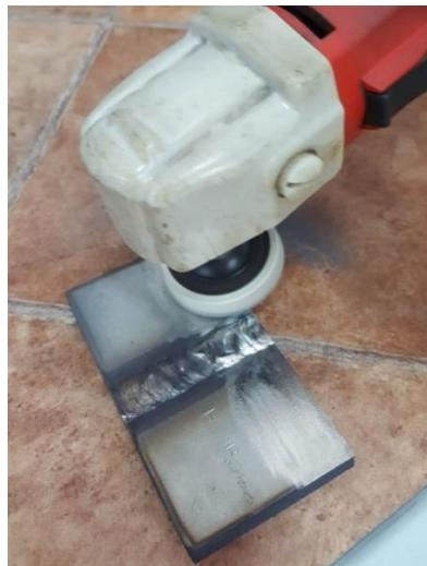
Slika 65. Mehanička obrada površine uzorka
