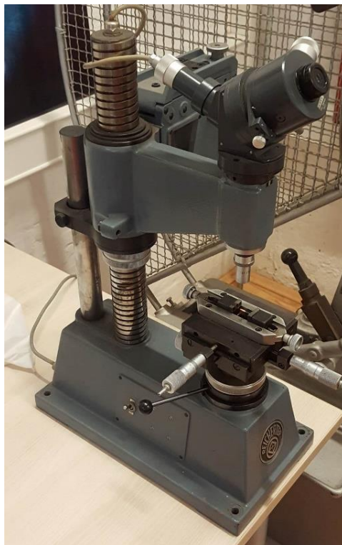
Slika 62. Uređaj za mjerenje tvrdoće
