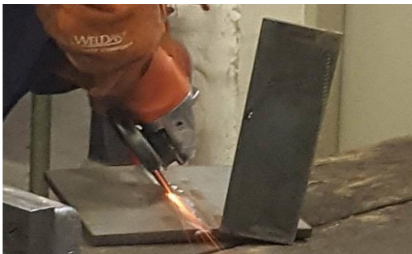
Slika 42. Brušenje korijena zavora - uzorak A
