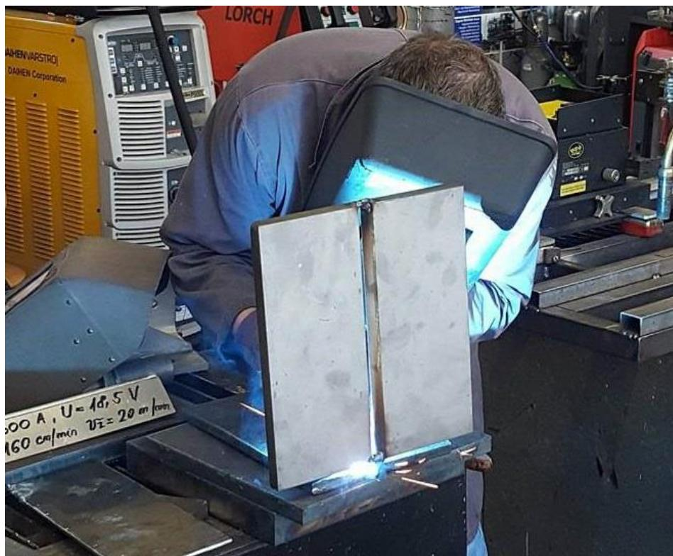
Slika 35. Pozicioniranje u vertikalni položaj i zavarivanje pripoja
