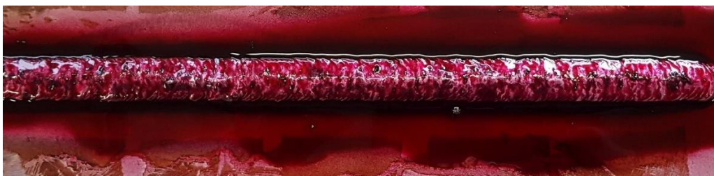
Slika 53. Uzorak B s nanesenim penetrantom - korijen zavara
