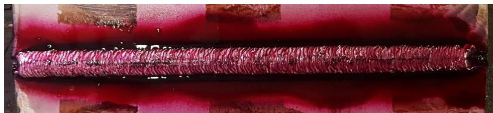
Slika 51. Uzorak A s nanesenim penetrantom - korijen zavara
