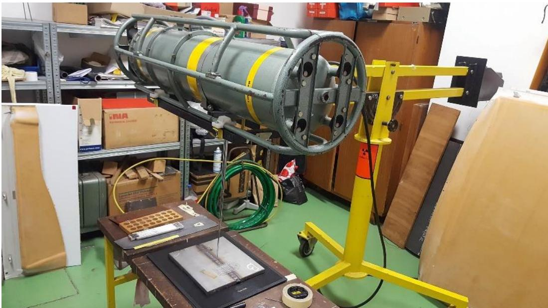
Slika 48. Uzorak pripremljen za radiografsko ispitivanje
