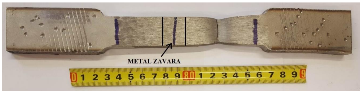
Slika 85. Uzorak B nakon statičkog vlačnog ispitivanja
