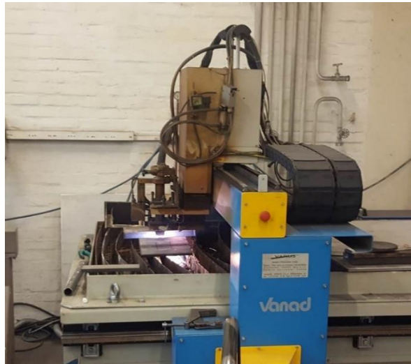
Slika 54. Rezanje uzoraka plazmom
