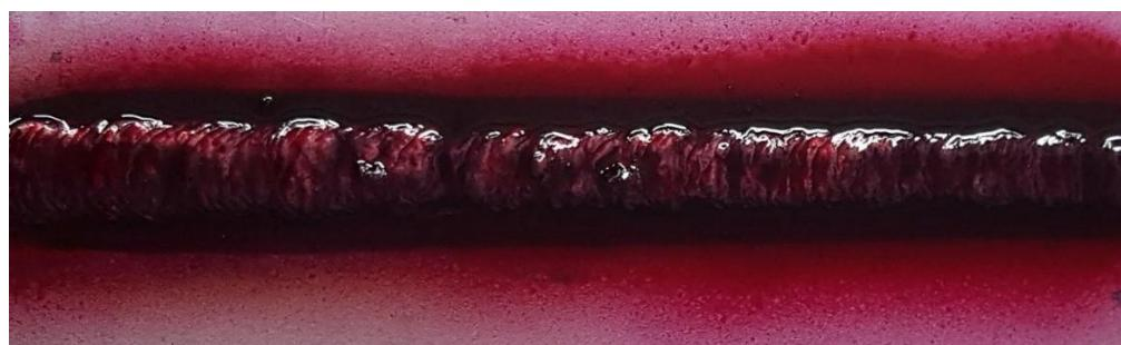
Slika 52. Uzorak B s nanesenim penetrantom - lice zavara
