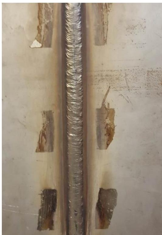
Slika 44. Izgled novog korijena zavara uzorka A
