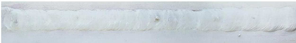
Slika 75. Uzorak B s nanesenim razvijačem - lice zavara
