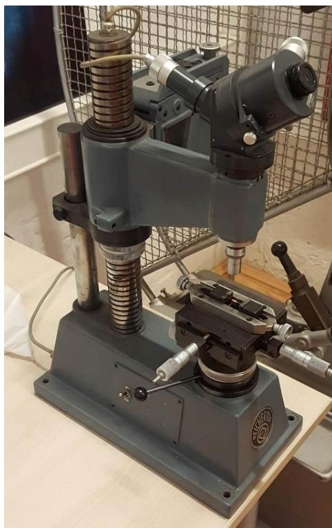
Slika 62. Uređaj za mjerjenje tvrdoće
