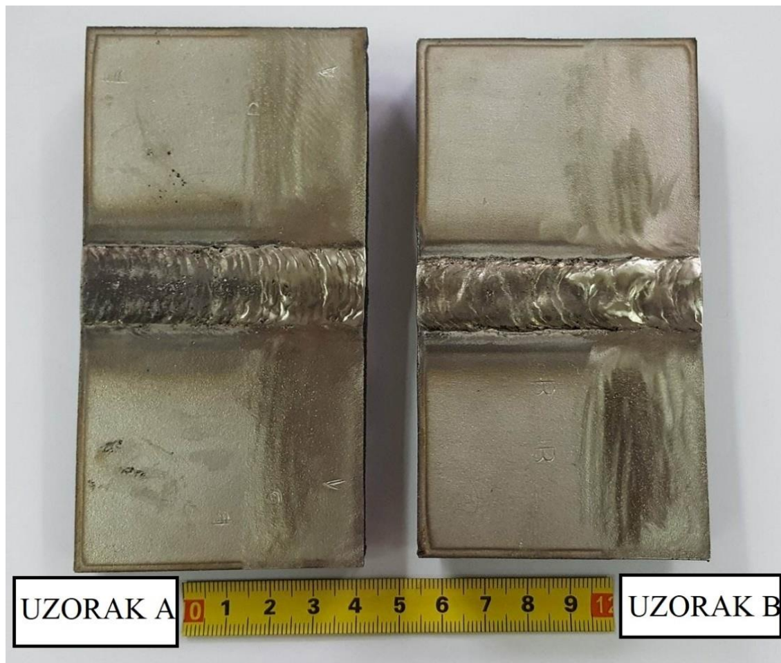
Slika 89. Izgled ispitnih uzoraka nakon izlaganja agresivnoj otopini
