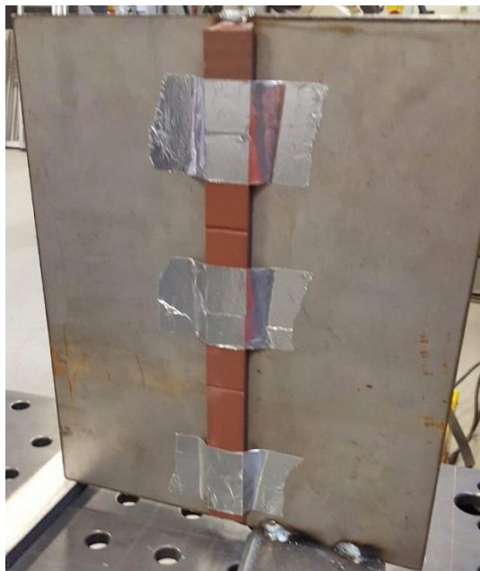
Slika 36. Postavljanje keramičke podloge
