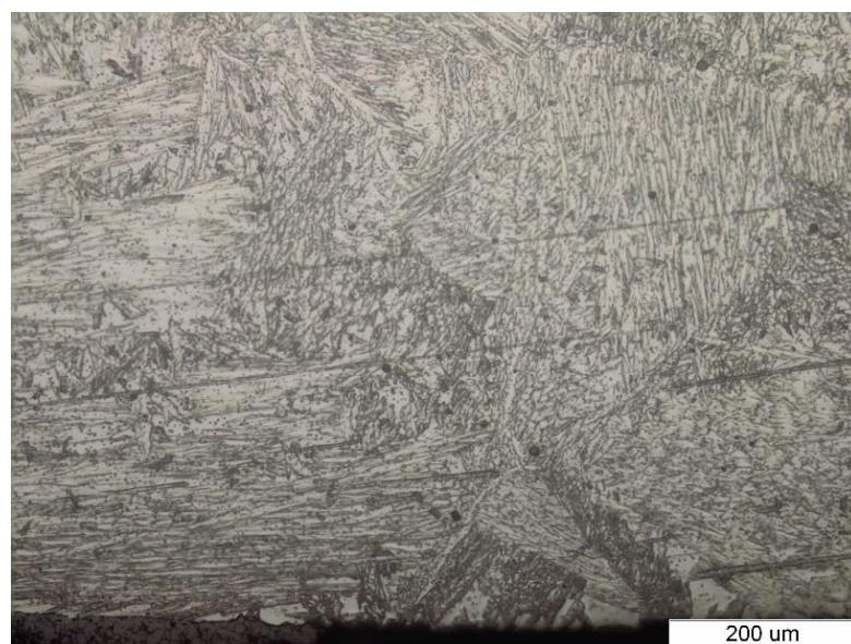
Slika 83. Mikrostruktura korijena zavara uzorka B, povećanje 200 x
