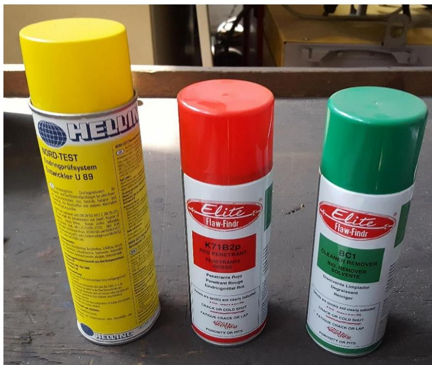
Slika 49. Razvijač, penetrant i čistač korišteni u postupku
