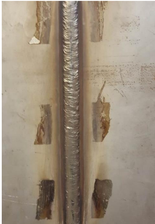
Slika 44. Izgled novog korijena zavara uzorka A
