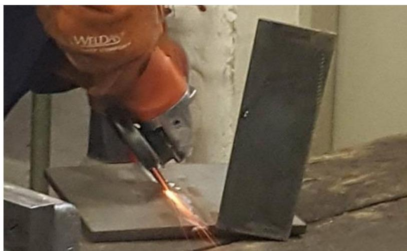
Slika 42. Brušenje korijena zavara - uzorak A
