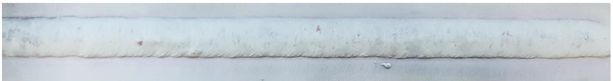
Slika 76. Uzorak B s nanesenim razvijačem - korijen zavora
