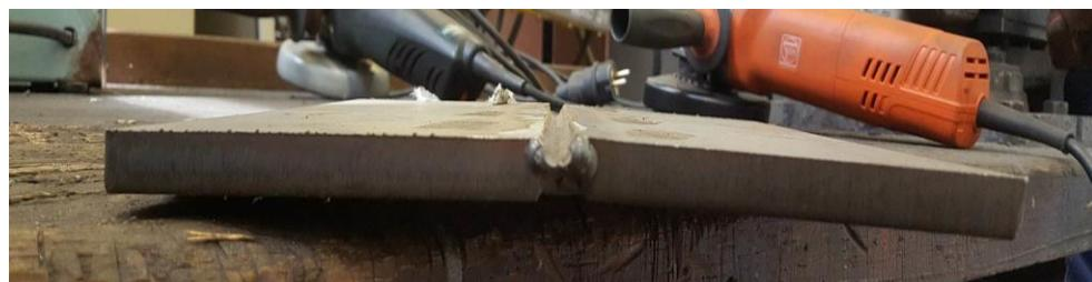
Slika 43. Izbrušen korijen zavara - uzorak A
