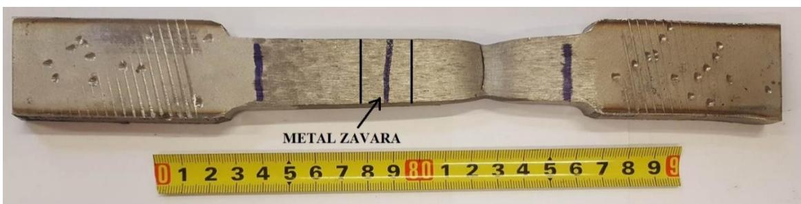
Slika 85. Uzorak B nakon statičkog vlačnog ispitivanja
