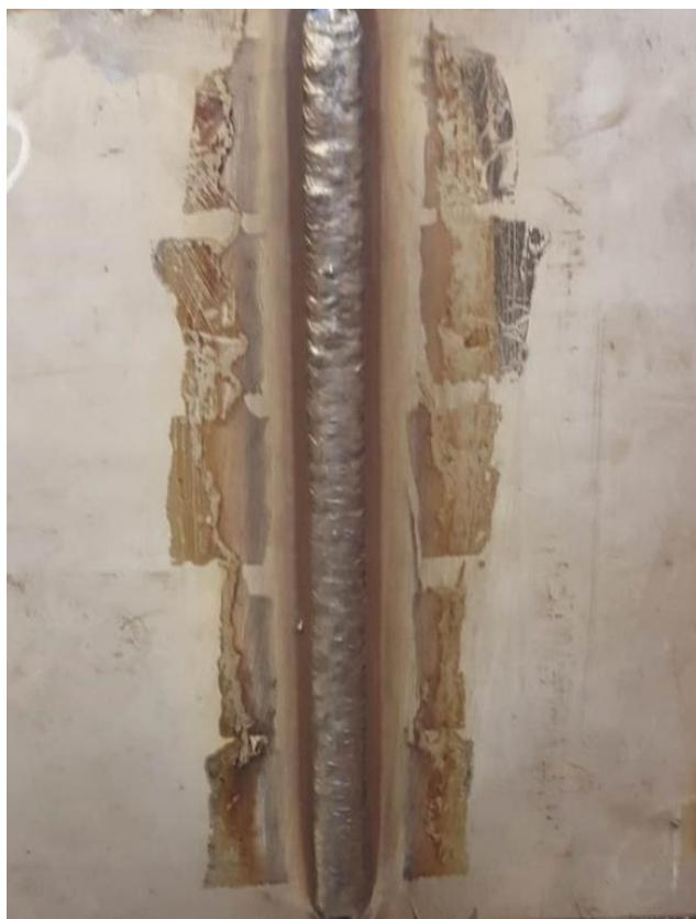
Slika 47. Izgled novog korijena zavara uzorka B
