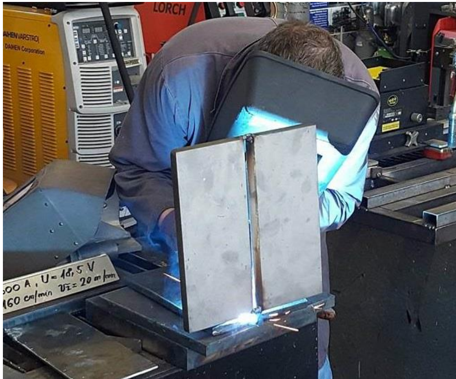
Slika 35. Pozicioniranje u vertikalni položaj i zavarivanje pripoja
