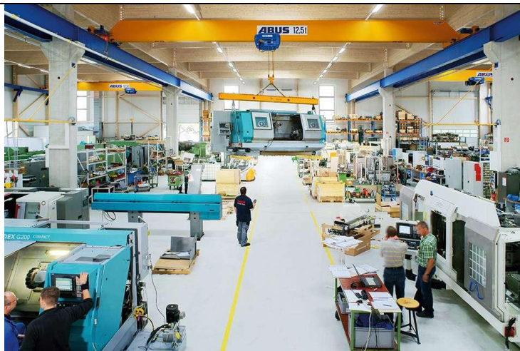
Slika 3. Mosni granik s jednim nosačem i jednim ovjesnim vitlom [4]
