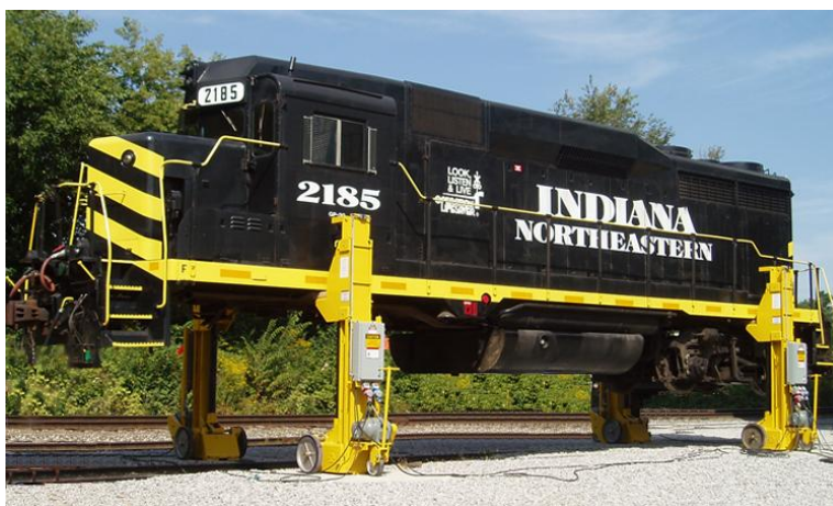
Slika 1. Podizanje lokomotive s četiri mobilne električne dizalice [1]
