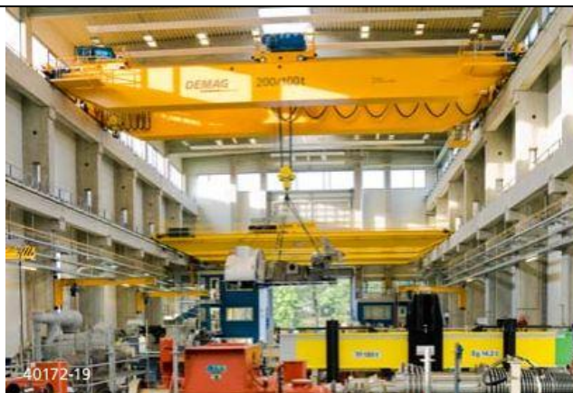
Slika 7. Mosni granik nosivosti 200 tona [8]
