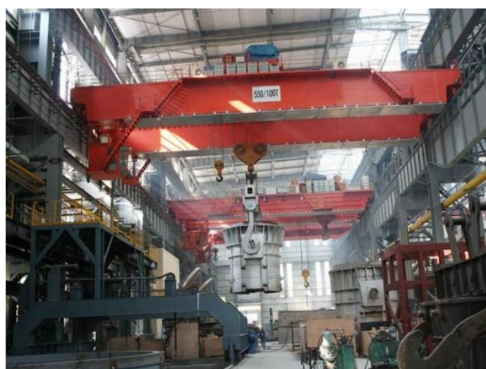
Slika 5. Mosni granik nosivosti 100 tona [6]
