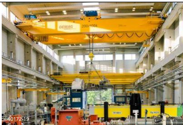
Slika 7. Mosni granik nosivosti 200 tona [8]
