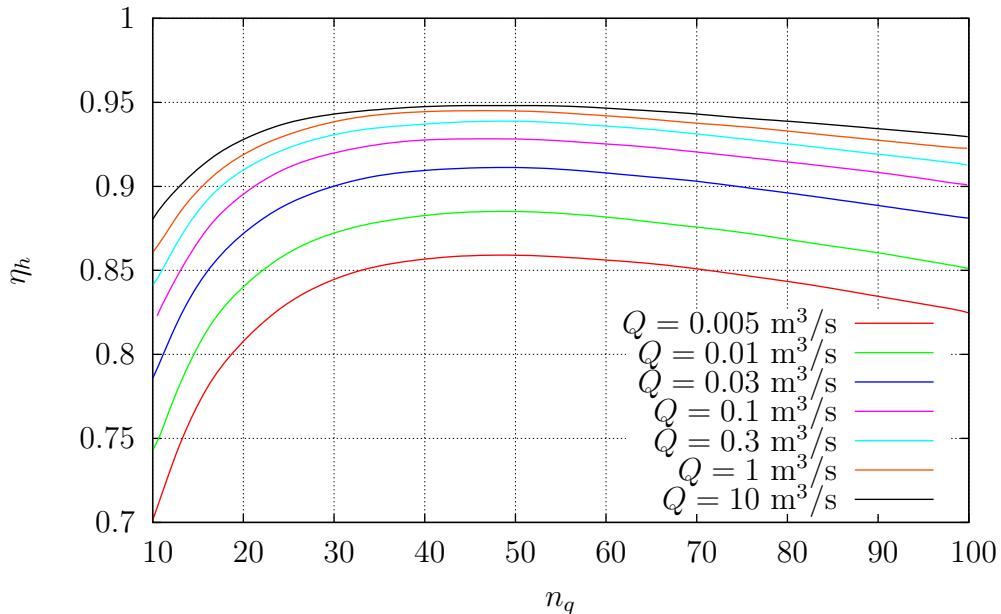
Slika 2.2: Hidraulička iskoristivost ovisno o brzohodnosti [1]
