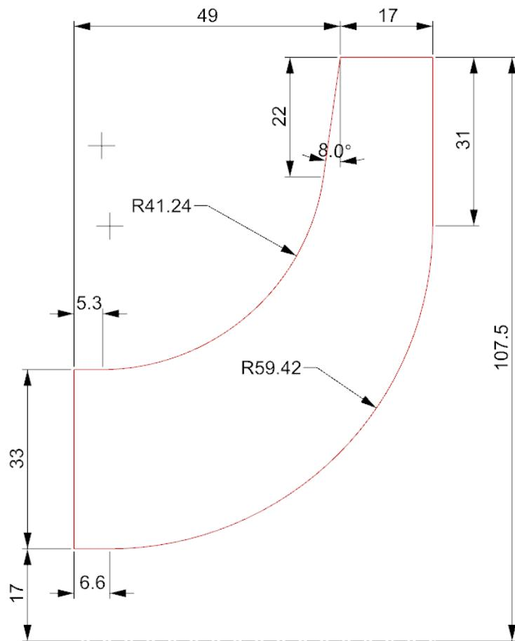
Slika 4.3: Dimenzije meridionalnog presjeka
