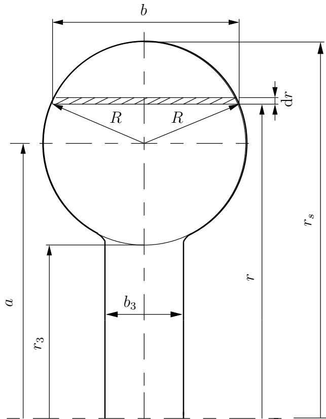
Slika 2.20: Dimenzije presjeka spiralnog kućišta s kružnim presjekom
