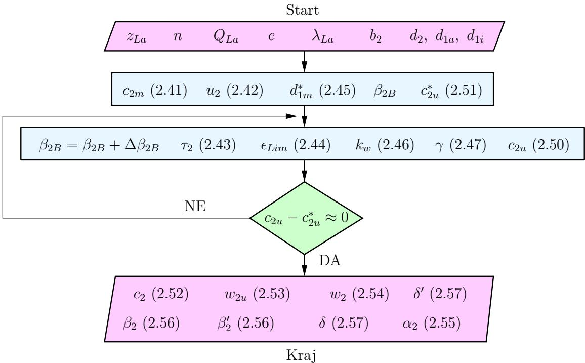
Slika 2.9: Iterativni postupak određivanja izlaznog kuta lopatice
