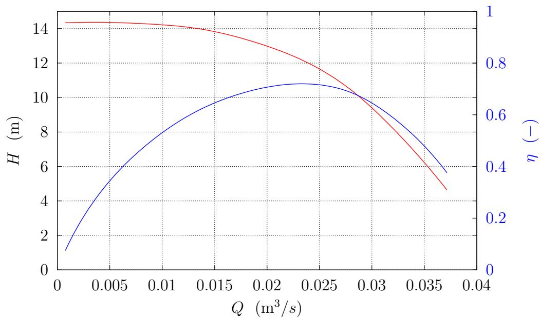
Slika 4.2: Radna karakteristika pumpe NN 80-200, promjer rotora 215 mm
