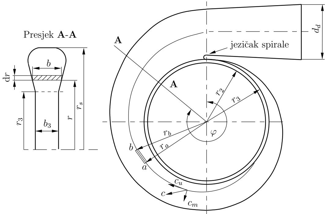
Slika 2.19: Spiralno kućište
