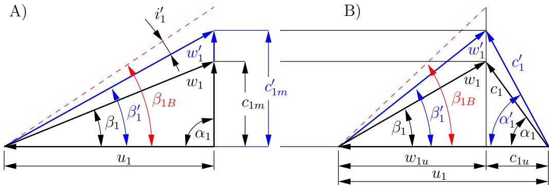
Slika 2.6: Ulagani trokut brzina: A) aksijalni ulaz toka, B) ulaz toka s vrložnom komponentom
