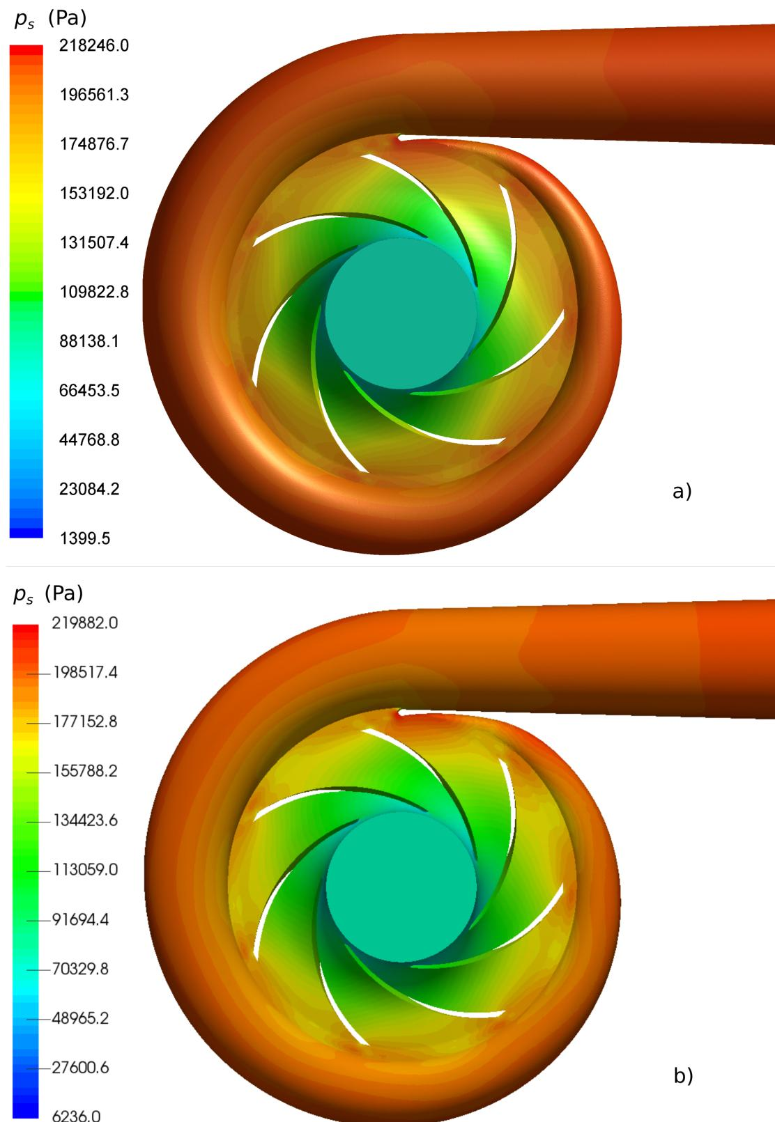
Slika 4.29: Polje statičkog tlaka,  $Q = 0.024 \text{ m}^3/\text{s}$ ,  $k - \varepsilon$  model turbulencije:
