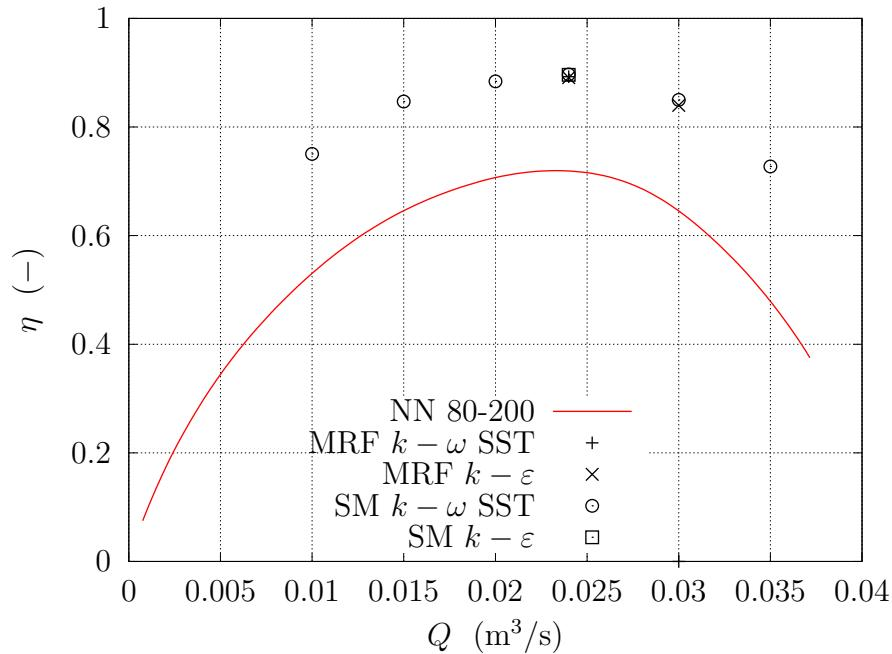
Slika 4.27: Rezultati simulacija na  $Q - \eta$  krivulji
