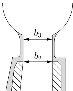
Slika 4.13: Modifikacija širine kanala spirale za potrebe numeričke simulacije
