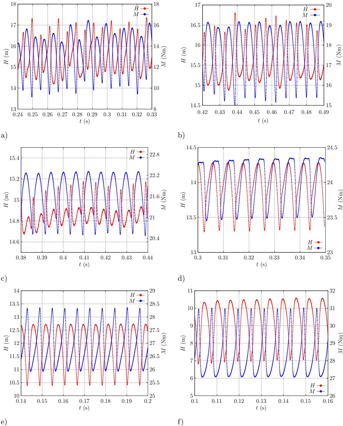
Slika 4.24: Rezultati nestacionarnih simulacija pomoću SM metode i  $k - \omega$
