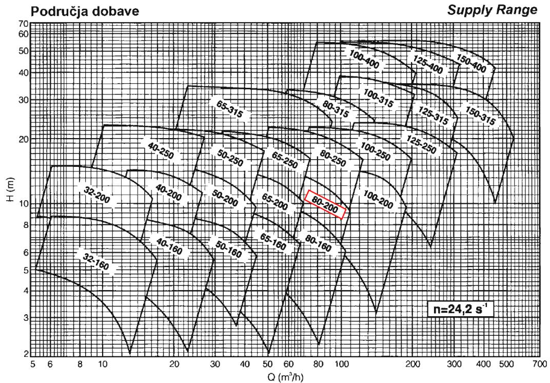
Slika 4.1: Radne karakteristike serije centrifugalnih pumpi za brzinu vrtnje
