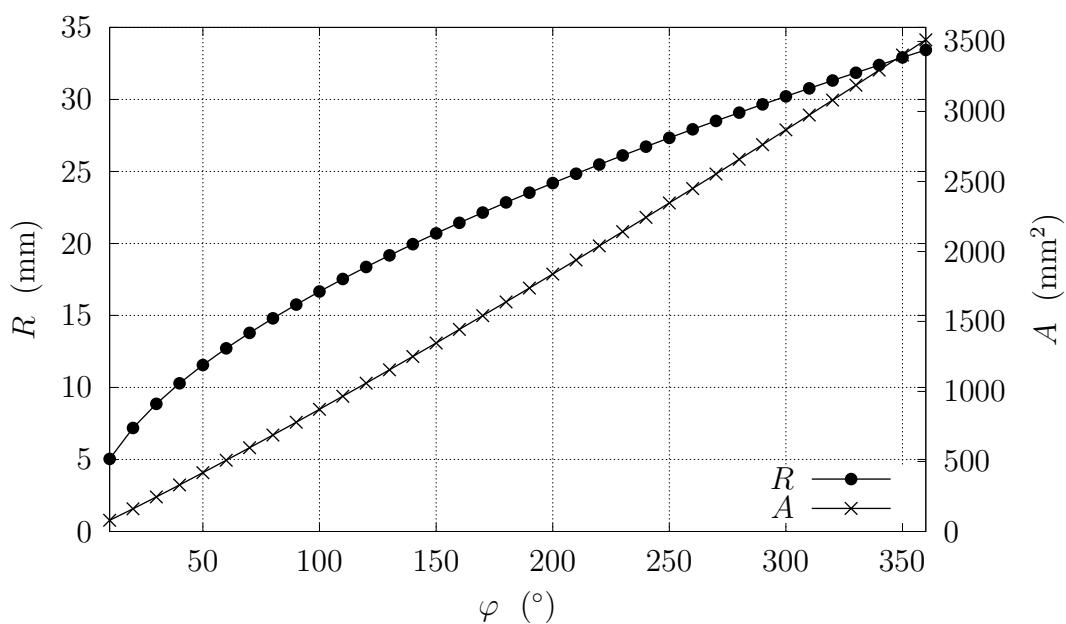
Slika 4.14: Ovisnost radijusa i površine poprečnog presjeka spiralnog kučišta o kutu  $\varphi$
