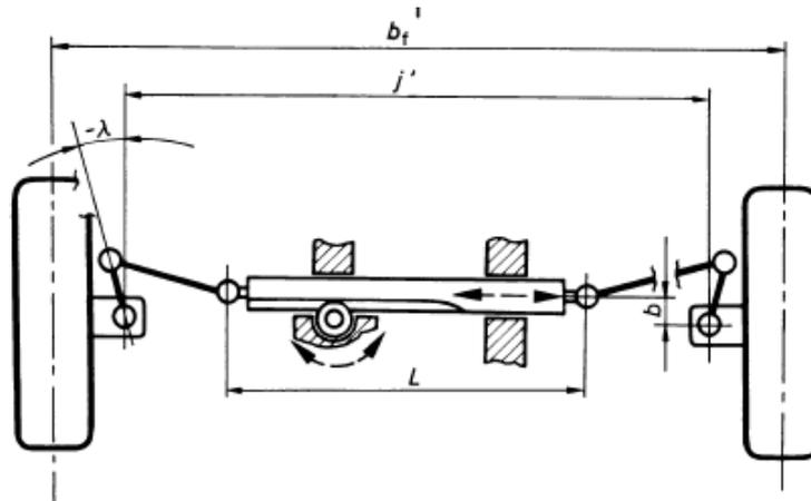
Slika 52. Mehanizam upravljanja [7]
