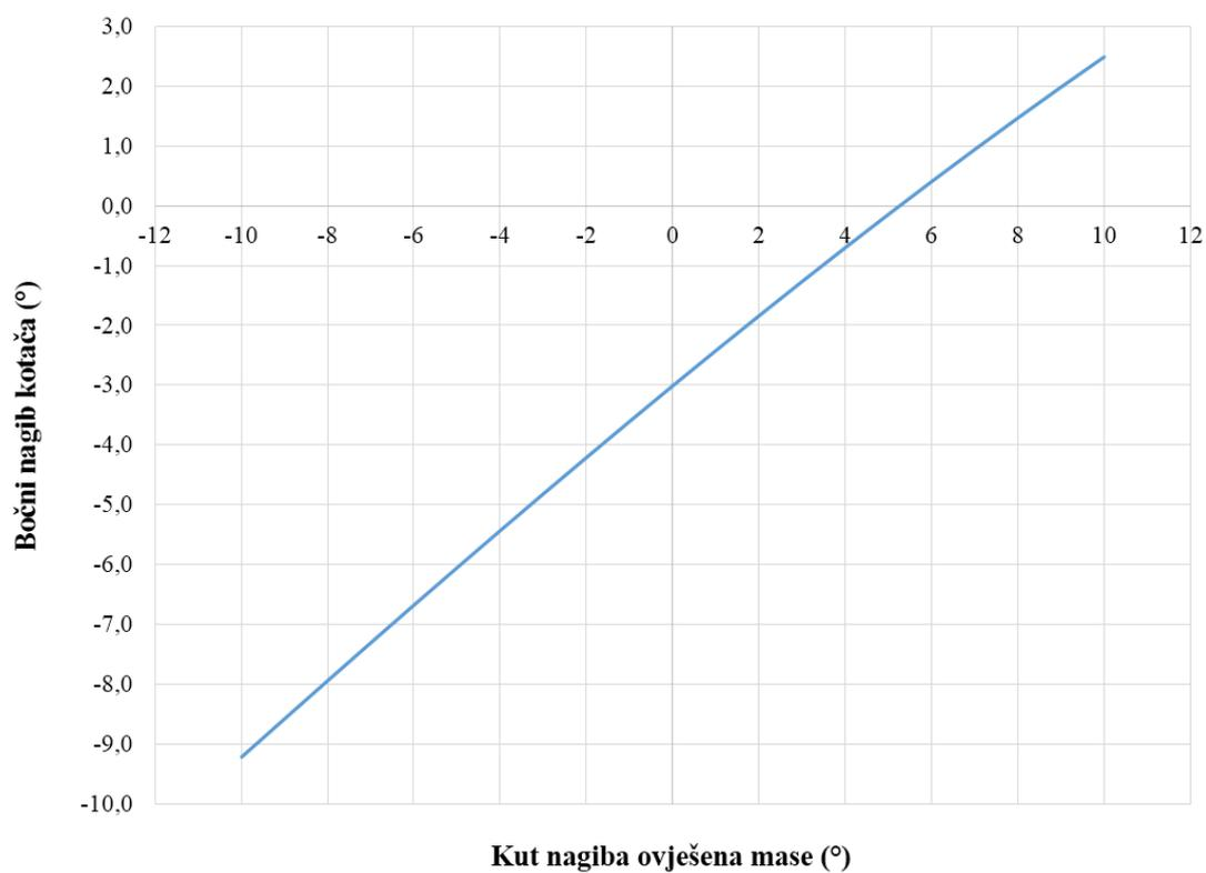
Slika 58. Promjena bočnog nagiba kotača (prednji ovjes)
