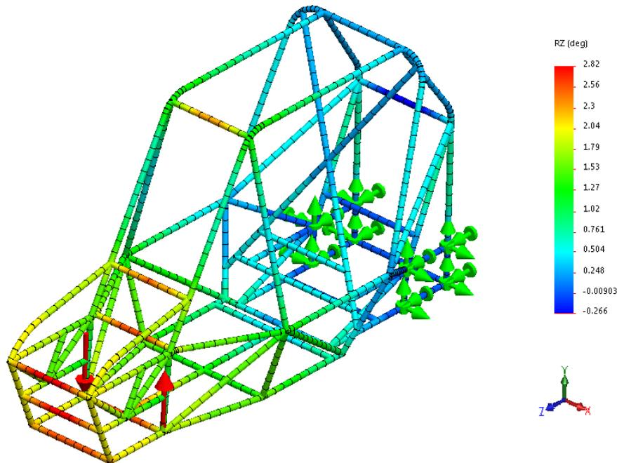
Slika 97. Kut zakreta u smjeru osi z
