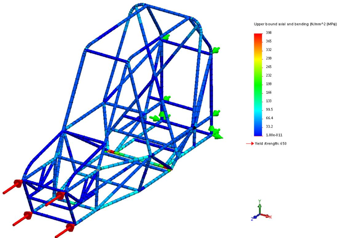
Slika 99. Naprezanja na šasiji zbog frontalnog udara
