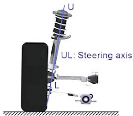
Slika 9. Os zakretanja kotača [4]
