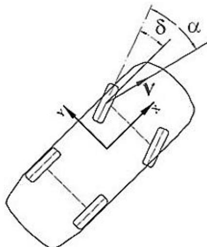
Slika 18. Kut upravljanja i kut bočnog klizanja [4]
