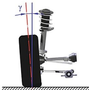
Slika 7. Bočni nagib kotača, pozitivan nagib [4]
