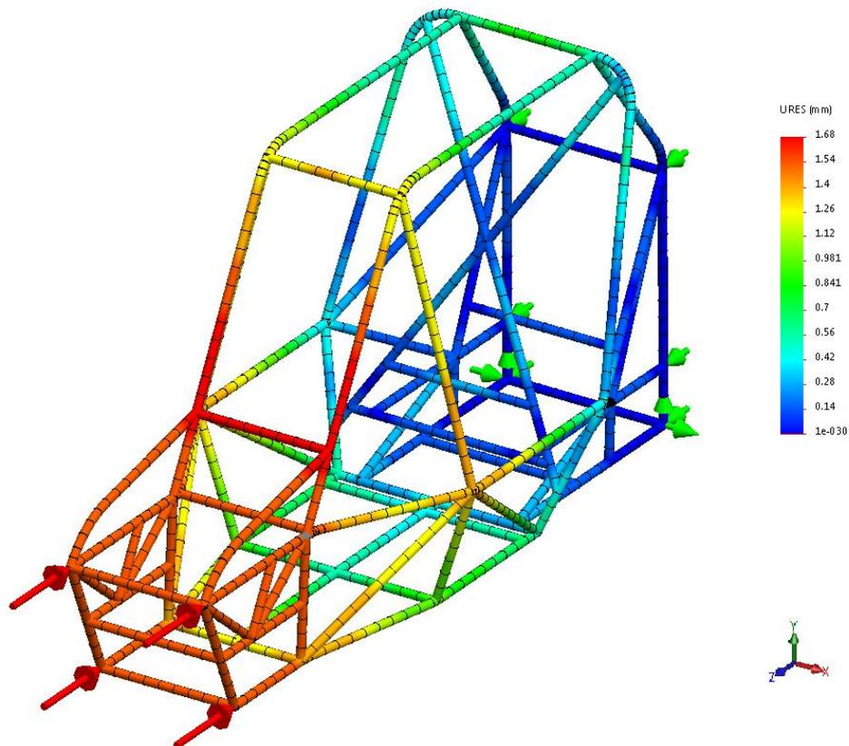
Slika 100. Deformacija šasije zbog frontalnog udara
