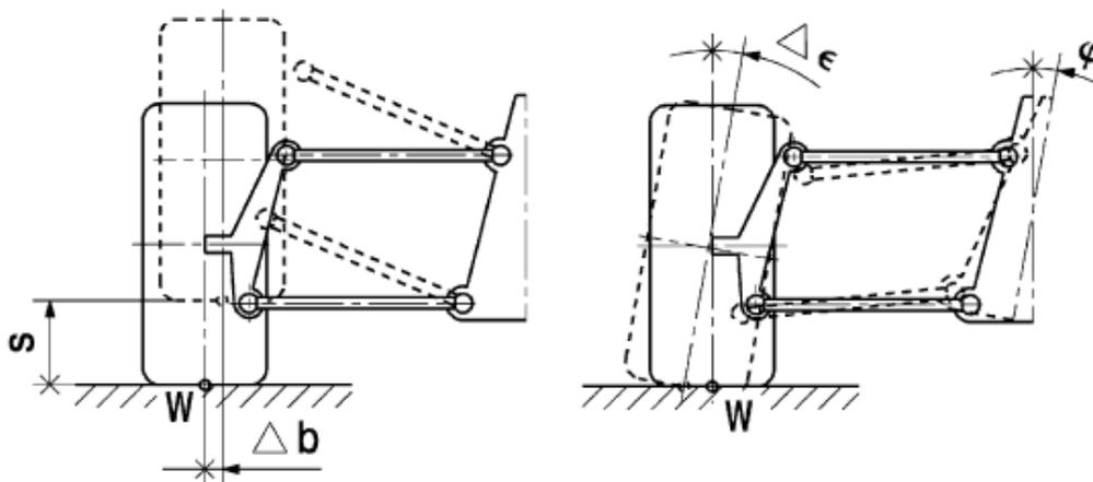
Slika 49. Promjena bočnog nagiba kotača (a) [6]
