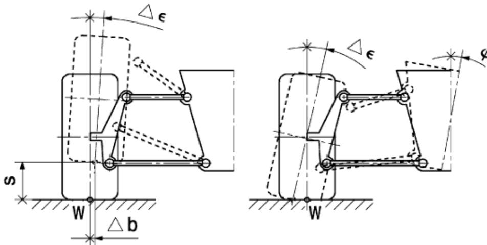
**Slika 50. Promjena bočnog nagiba kotača (b) [6]**
