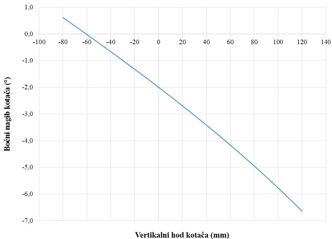
Slika 63. Promjena bočnog nagiba kotača (stražnji ovjes)
