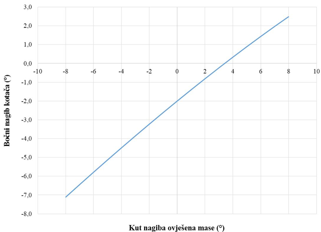
Slika 67. Promjena bočnog nagiba kotača (stražnji ovjes)
