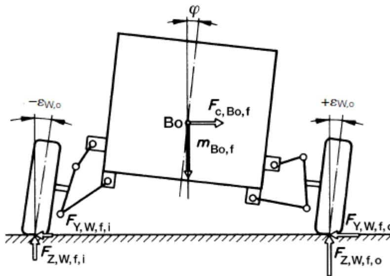
Slika 25. Djelovanje sila na vozilo u lijevom zavoju [7]
