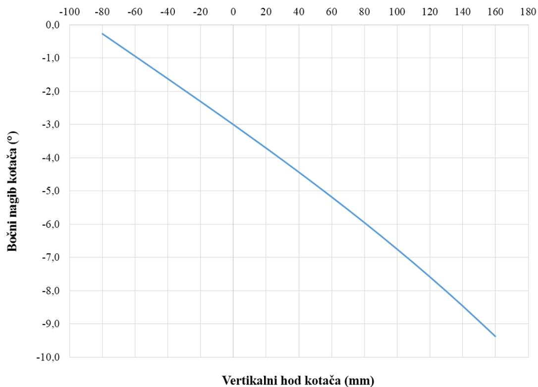
Slika 54. Promjena bočnog nagiba kotača (prednji ovjes)
