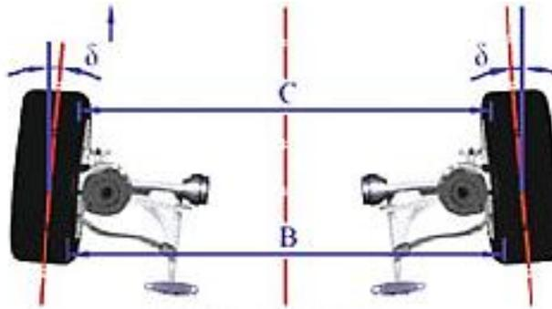
Slika 8. Usmjerenost kotača [4]
