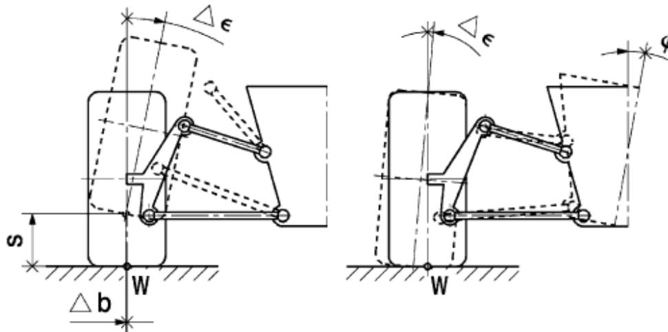
Slika 51. Promjena bočnog nagiba kotača (c) [6]
