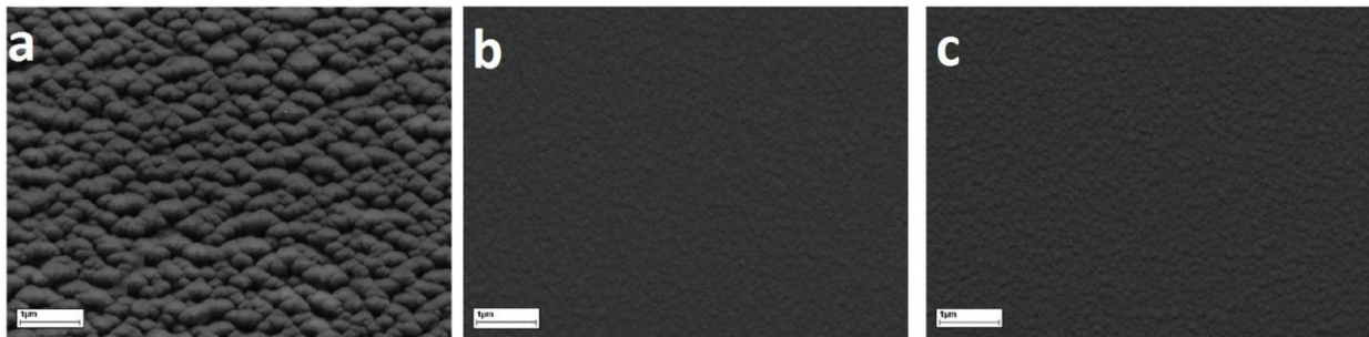
Slika 2.4 Topografija a) ruba vertikalno orijentiranog b) sredine vertikalno orijentiranog i c) horizontalno orijentiranog uzoraka [6]
