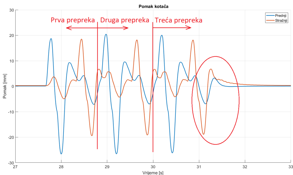
Slika 63. Pomaci kotača prilikom nailaska na tri poprečne prepreke
