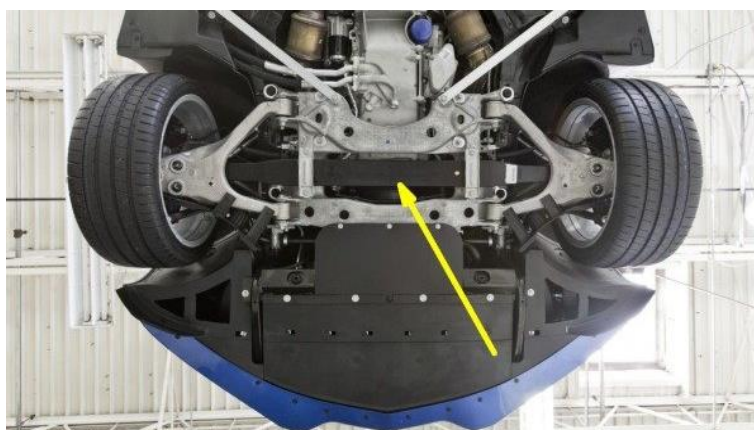
Slika 4. Lisnata opruga na Chevrolet Corvette
