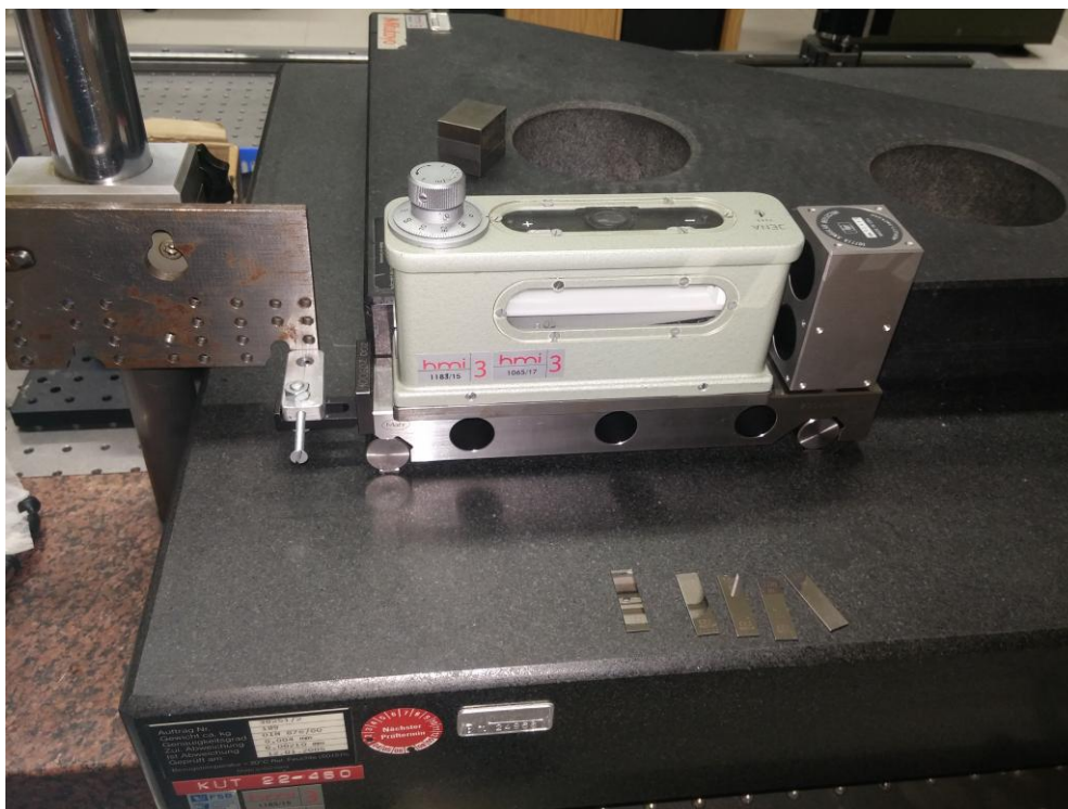
Slika 33. Postavljanje mjernog sustava za umjeravanje libele
