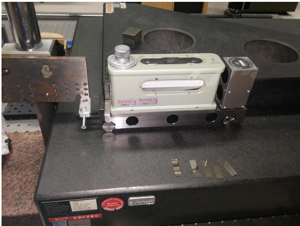
Slika 33. Postavljanje mjernog sustava za umjeravanje libele
