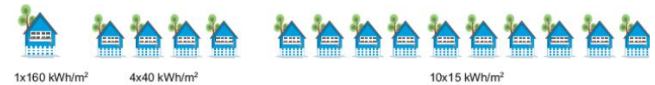
Sl.12. Usporedba potrošnje energije u standardno izoliranoj kući, niskoenergetske i pasivnoj kući.
