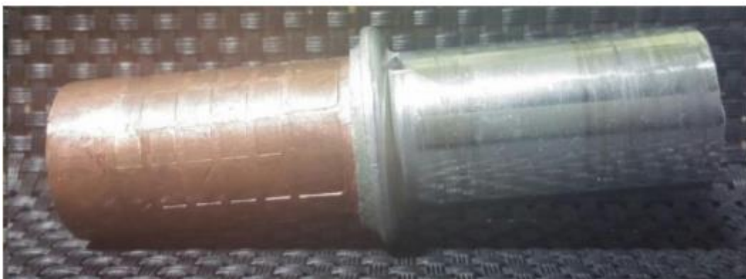
Slika 6. Spoj Al i Cu postupkom zavarivanja rotacijskim trenjem [6]
