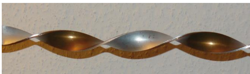
Slika 14. Al-Cu traka nakon postupka laserski induciranog prevlačenja [24]
