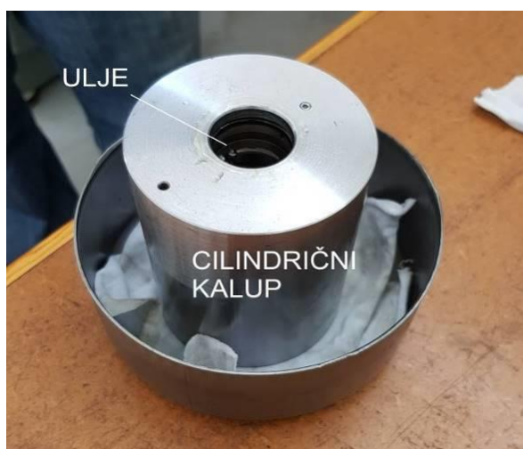
Slika 28. Cilindar s uljem pripremljen za CIP
