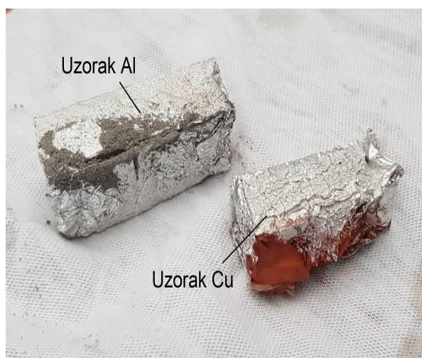
Slika 29. Uzorci u Al foliji nakon CIP-a
