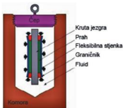
Slika 18. CIP postupak [25]
