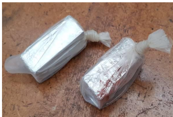
Slika 27. Uzorci u elastomernoj vrećici
