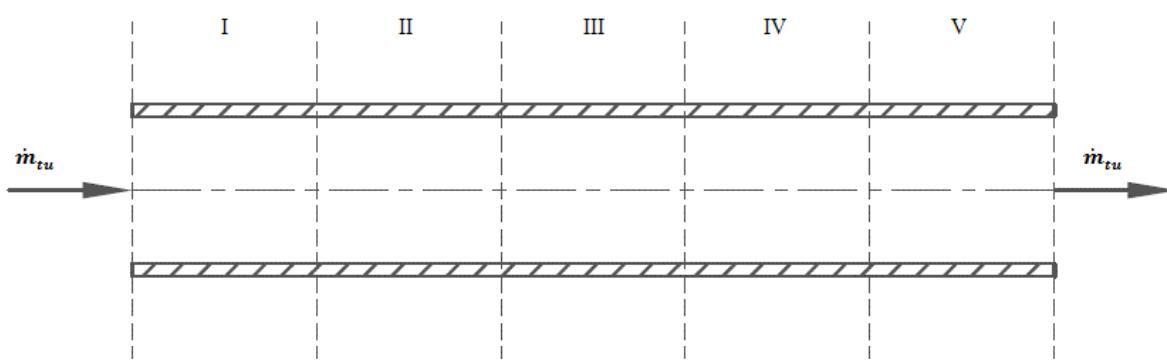
**Slika 18. Povratna i dobavna cijev podijeljena na segmente**
