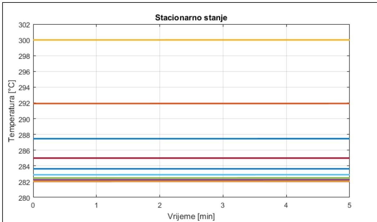
Slika 26. Odziv temperatura po segmentima za termo ulje unutar termoulnjnog kotla
