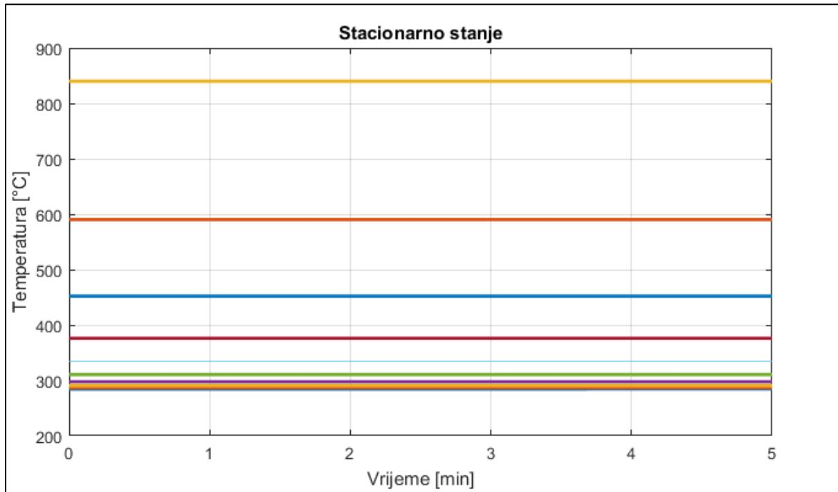
Slika 25. Odziv temperatura po segmentima za dimne plinove unutar termoulnjnog kotla
