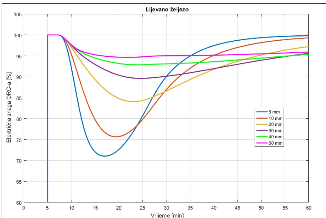
Slika 37. Toplinski spremnik od lijevanog željeza smješten umjesto dobavne cijevi
