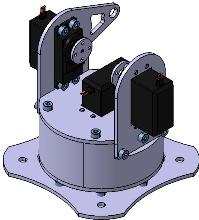
Slika 17. Model gotovog glavnog nosača
