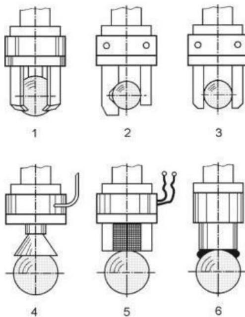
**Slika 7. Mogućnosti prihvaćanja radijalnih i sfernih objekata**
