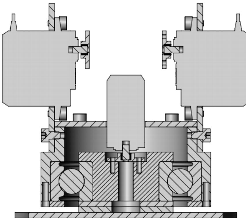
**Slika 16. Prikaz načina prijenosa rotacije glavnog nosača**
