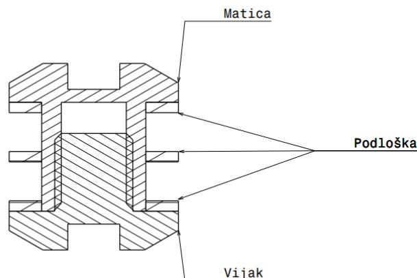
**Slika 5. Prikaz spojnica u presjeku**
