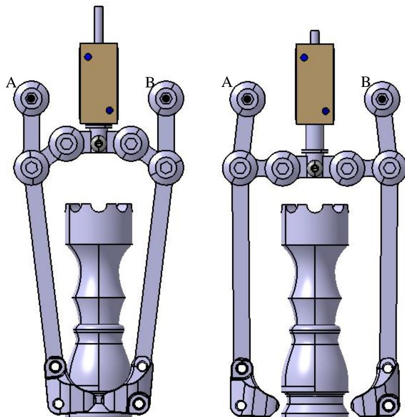
**Slika 13. Izgled zatvorene (lijevo) i otvorene (desno) hvataljke**
