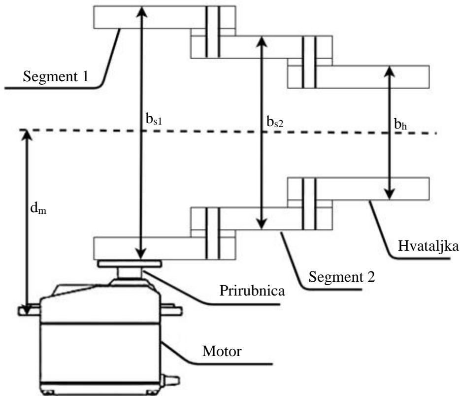
**Slika 15. Prikaz širina dijelova robota**
