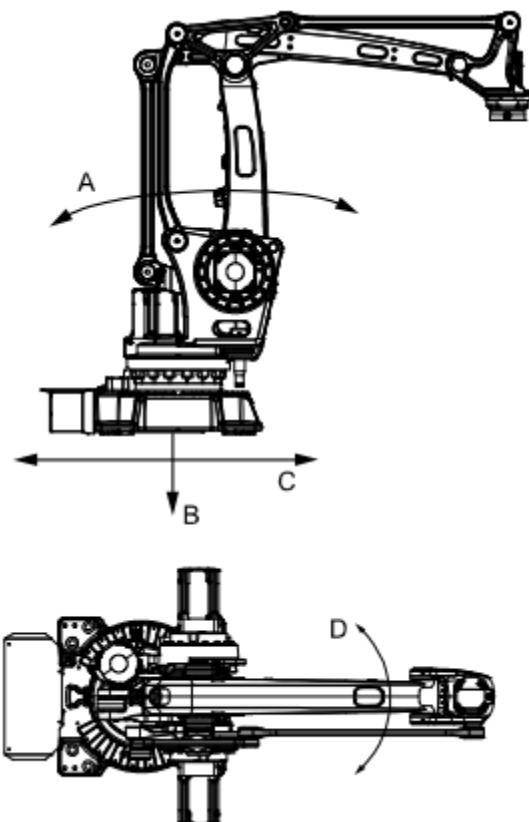
**Slika 3. Primjer industrijskog paletizirajućeg robota ABB IRB 460**
