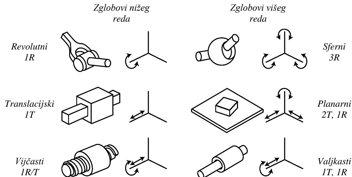
Slika 1. Pasivni zglobovi s različitim stupnjevima slobode
