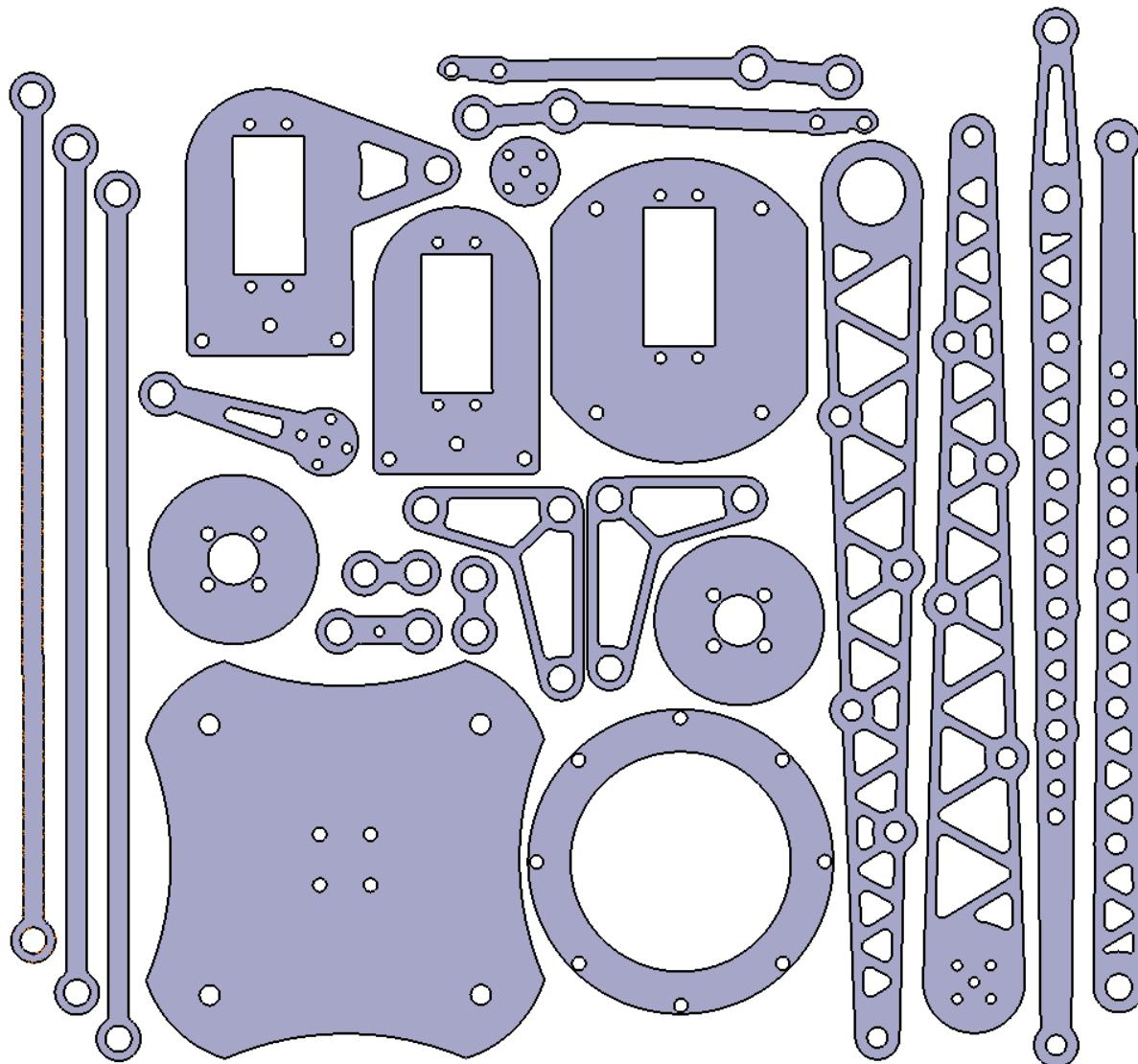
Slika 20. Raspored dijelova na pripremi za lasersko rezanje
