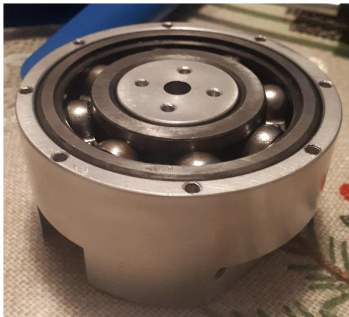
**Slika 21. Sklop dijelova izrađenih tokarenjem i glodanjem**
