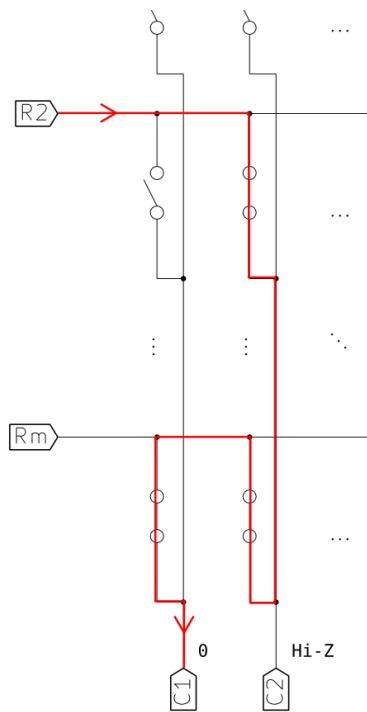
Slika 32. Primjer ghosting-a kod matričnog spajanja prekidača
