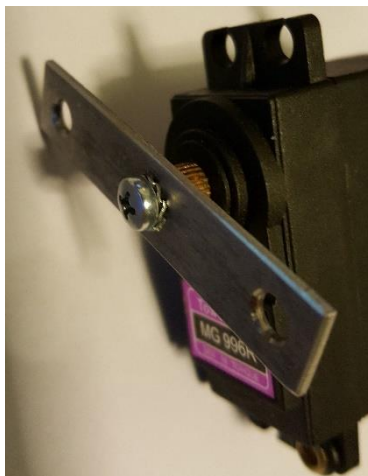
Slika 17. Spoj nastavka i vratila servomotora
