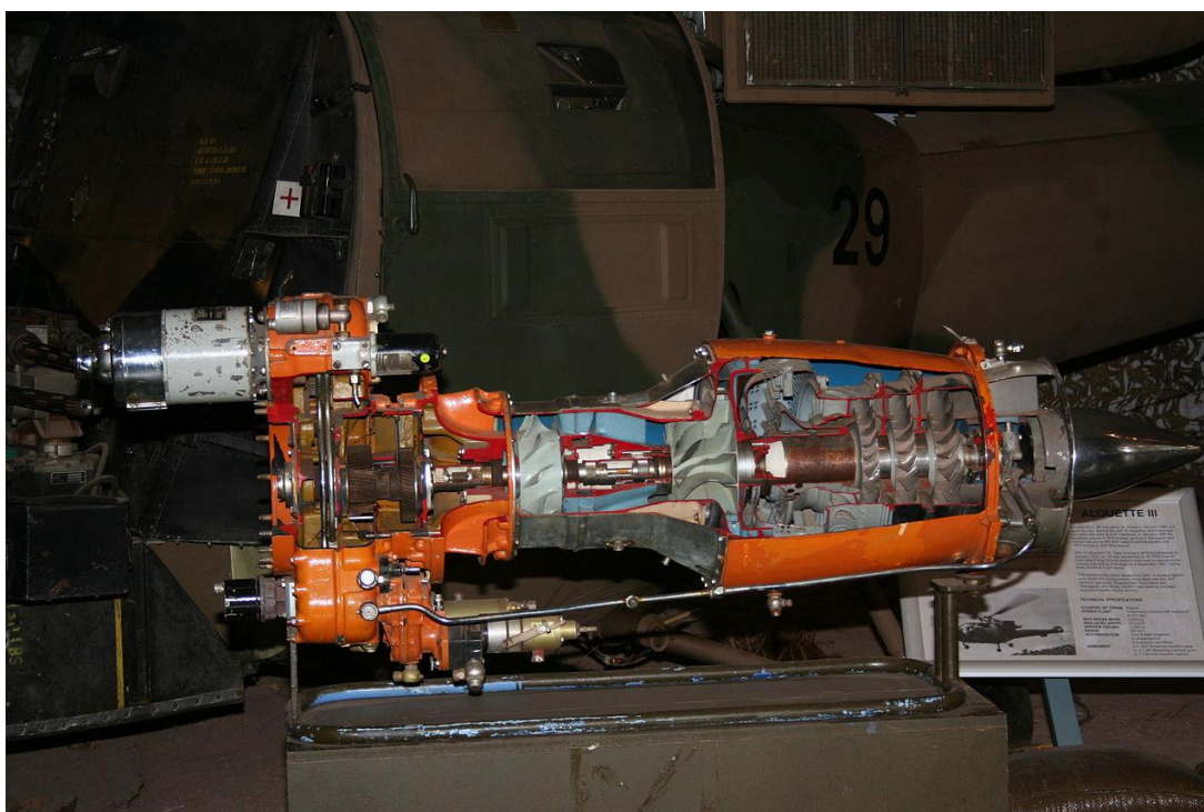
Slika 5. Djelomični presjek turbo motora GTM ASTAZOU III B [9]
