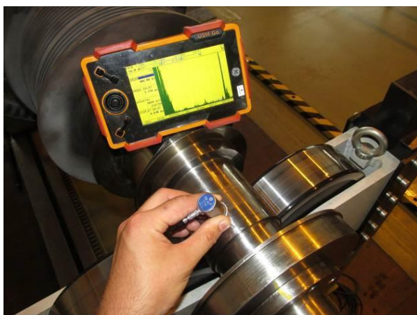
Slika 30. Prednji ležaj rukavca (MP=100 mm, RO=59 dB) [16]
