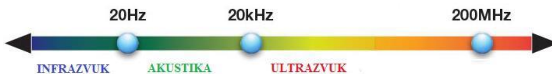
Slika 18. Podjela zvučnih valova prema frekvencijama [14]
