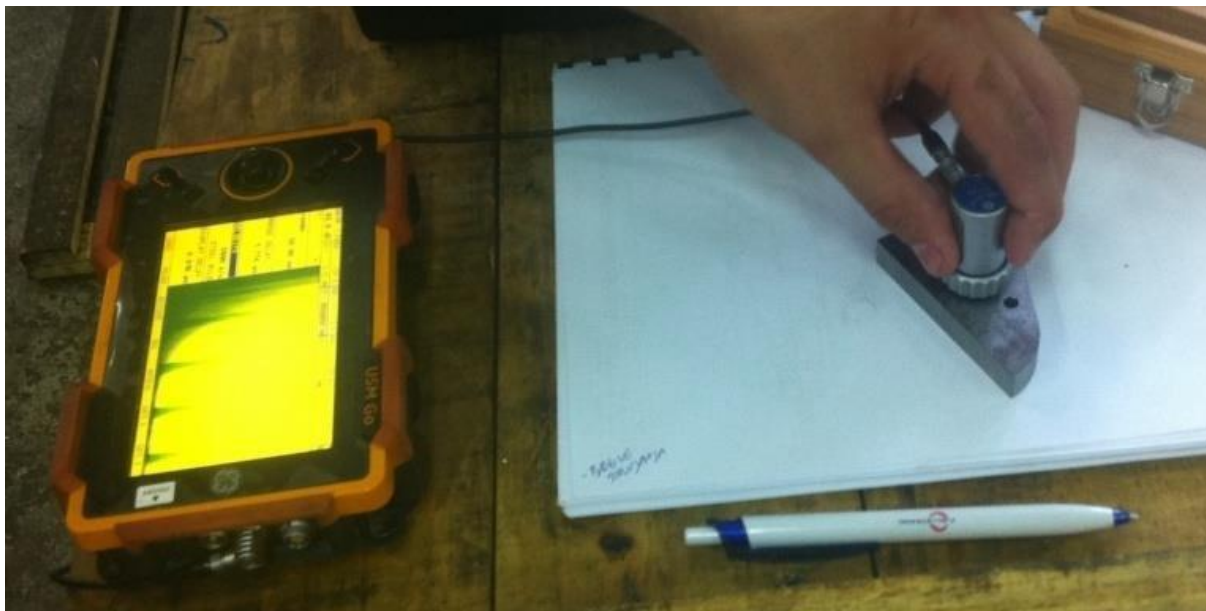
Slika 27. Baždarenje sondom na BD=12.5 mm MP=50 mm [16]
