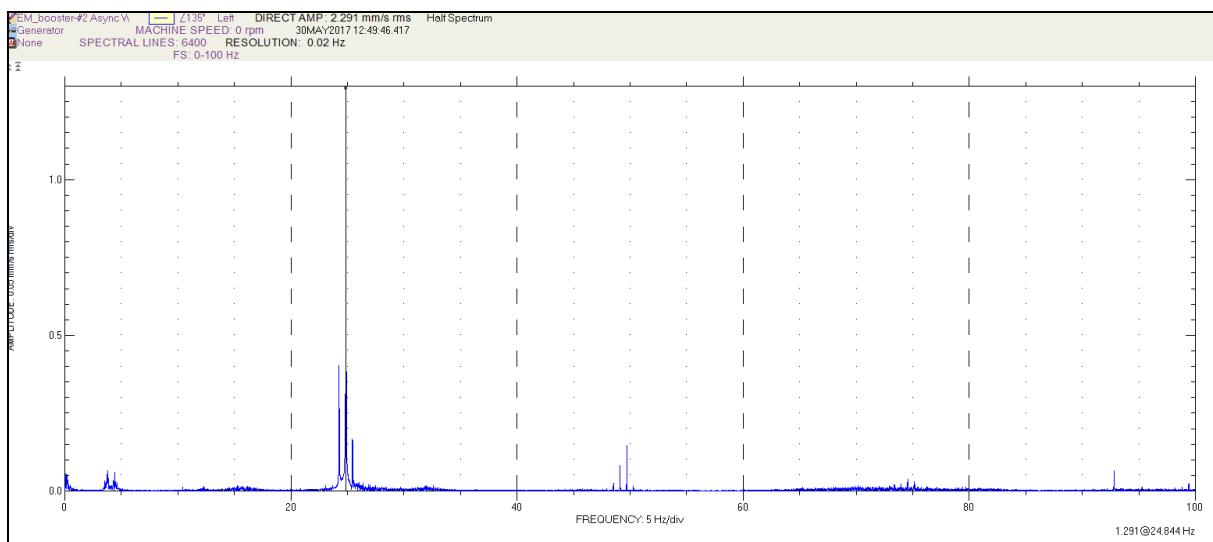
**Slika 44. Spektar mjernog mjesta elektromotora Booster pumpe 2501 [19]**
