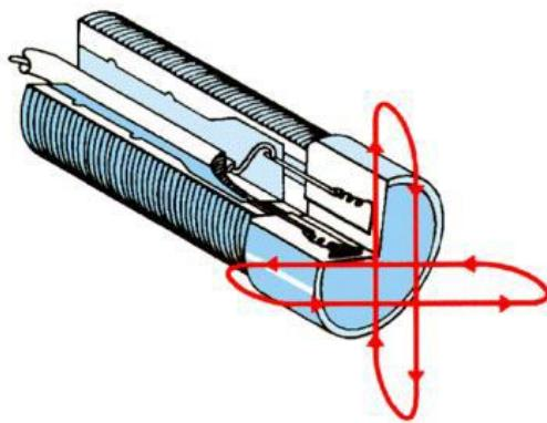
**Slika 36. Beskontaktni senzor pomaka [18]**
