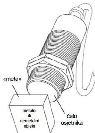
**Slika 37. Kapacitivni senzor pomaka [16]**
