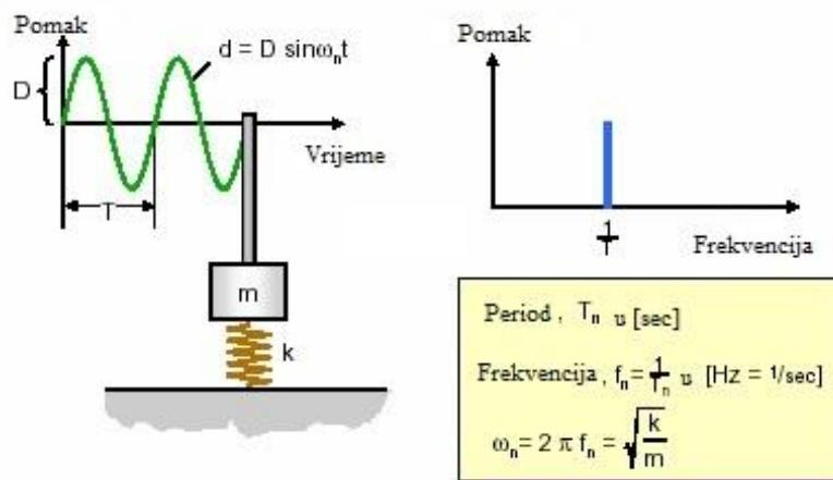
Slika 33. Najjednostavniji oblik oscilirajućeg sustava – model masa-opruga [17]
