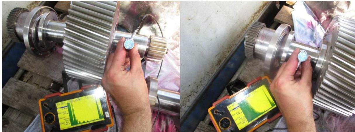
**Slika 29. Ispitivanje ležajnih rukavaca kod pogonskog zupčanika [16]**
