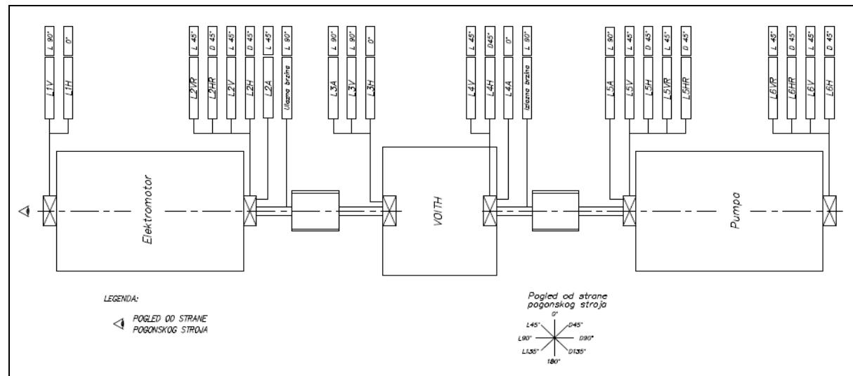
Slika 46. Raspored mjernih mesta linije glavnog pumpnog agregata P-2603
