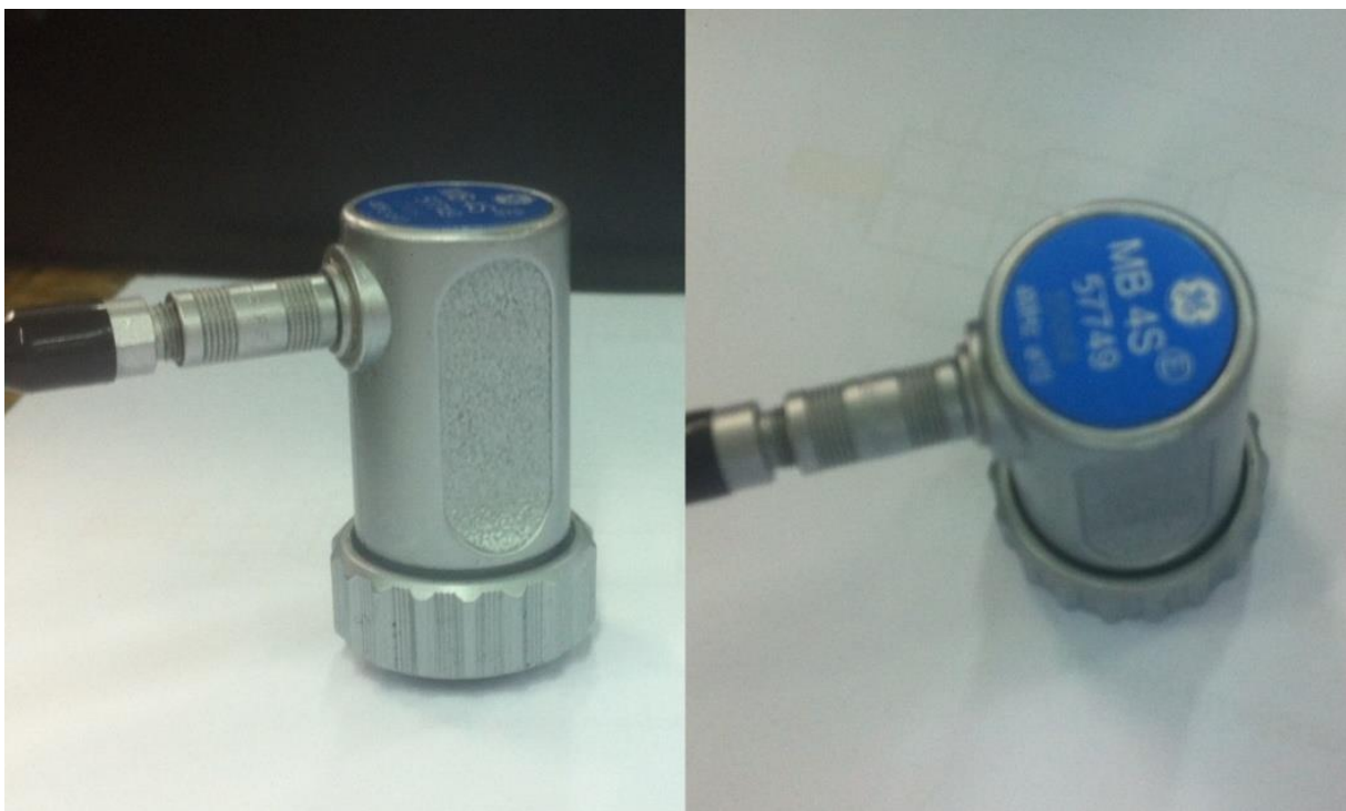
Slika 25. Sonda MB 4S [16]
