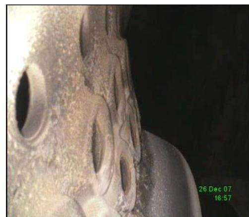
Slika 11. Komora sagorijevanja [5]
