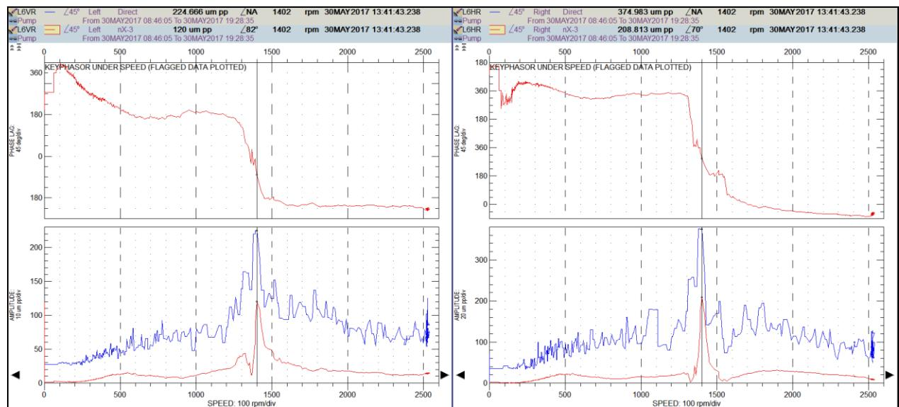
Slika 51. Promjena amplituda i faznih kuteva mjernog mjestu L6VR [19]
