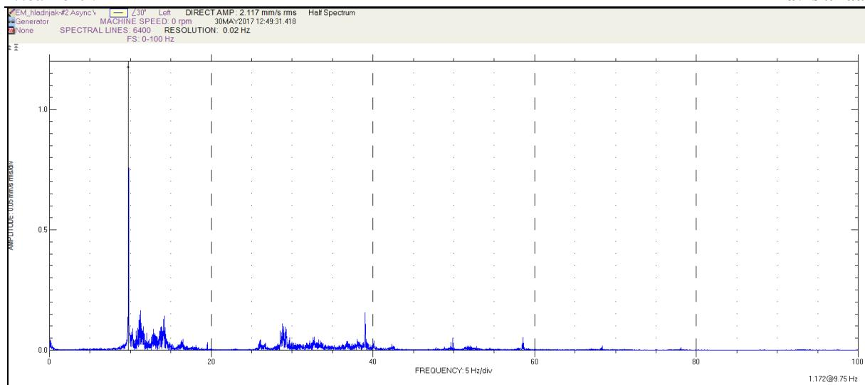
**Slika 43. Spektar mjernog mjesto ventilatora zračnog hladnjaka [19]**
