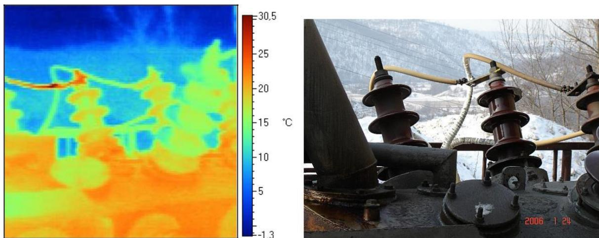
**Slika 17.** Termografska i normalna fotografija izolatora trafostanice 35/10 kV [13]
