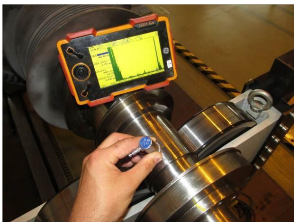
Slika 30. Prednji ležaj rukavca (MP=100 mm, RO=59 dB) [16]
