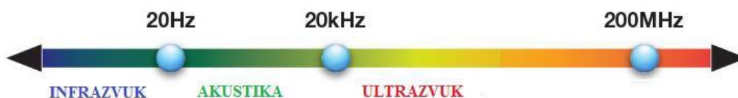
Slika 18. Podjela zvučnih valova prema frekvencijama [14]
