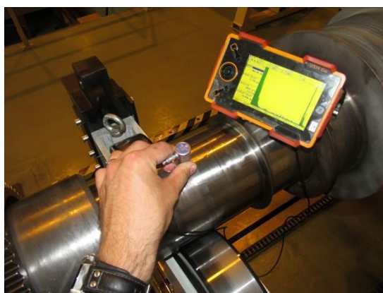
Slika 32. Stražnji ležaj rukavca (MP=140 mm, RO = 58 dB) [16]
