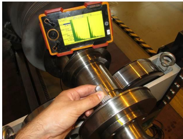
Slika 31. Disk (MP= 50 mm, RO= 43 dB) [16]
