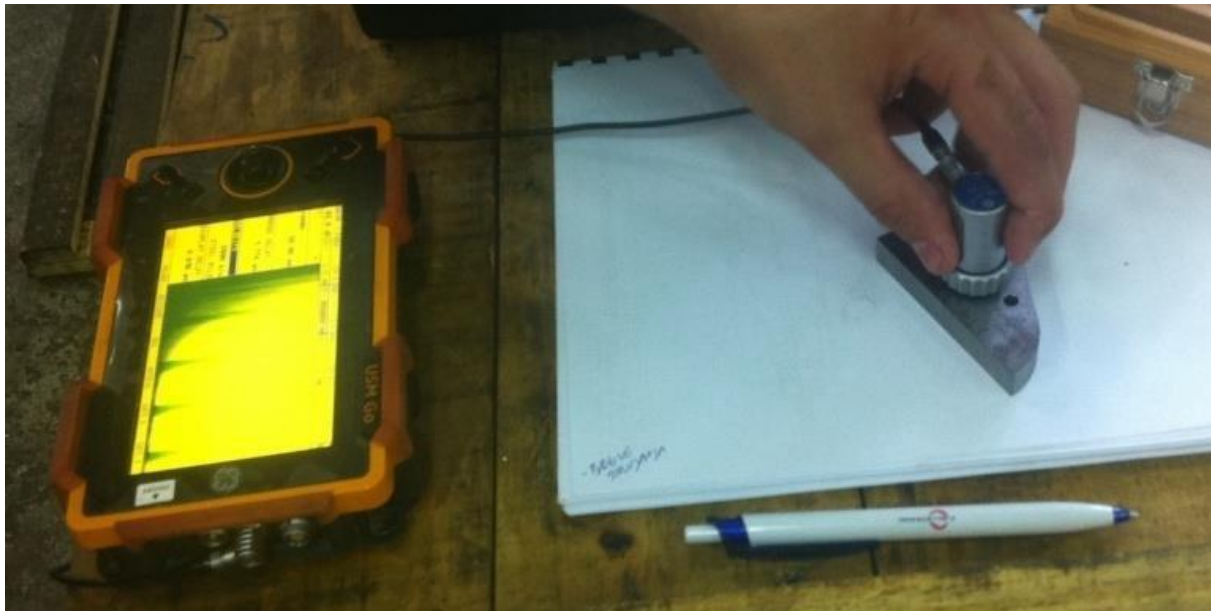
Slika 27. Baždarenje sondom na BD=12.5 mm MP=50 mm [16]
