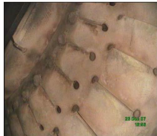
Slika 7. Komora sagorijevanja [5]
