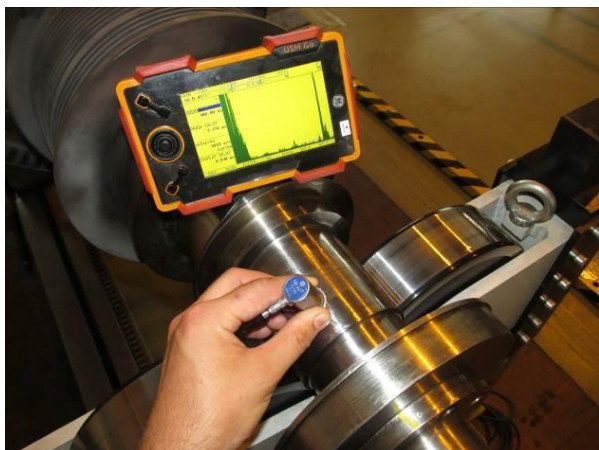
Slika 30. Prednji ležaj rukavca (MP=100 mm, RO=59 dB) [16]
