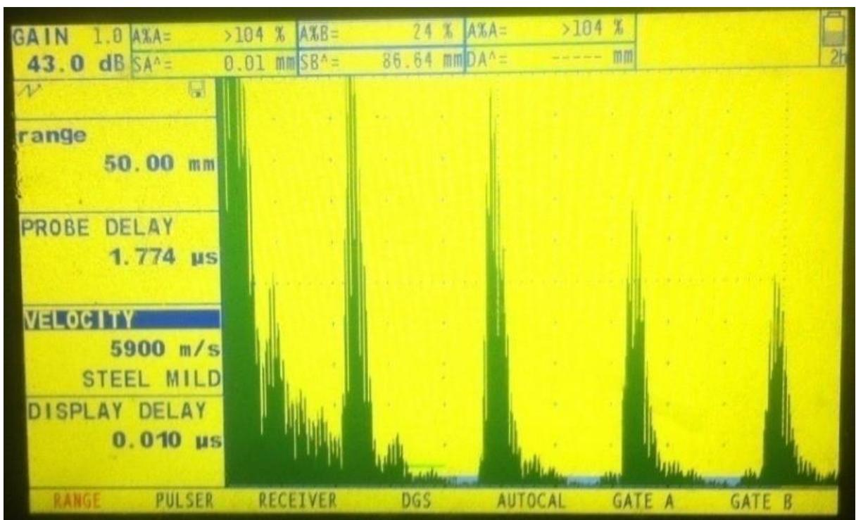
Slika 28. Pozicije signala na ultrazvučnom uređaju [16]
