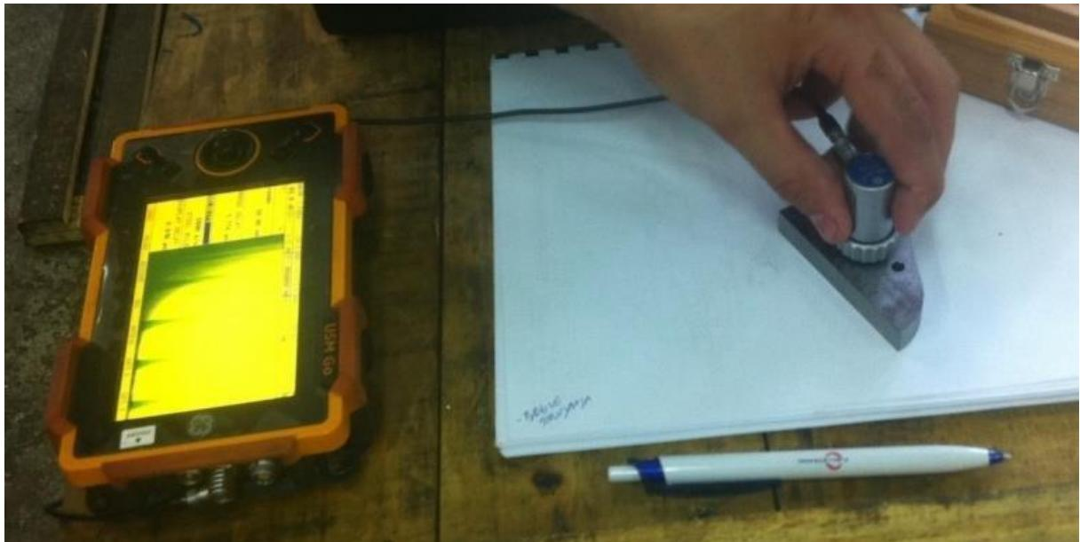
Slika 27. Baždarenje sondom na BD=12.5 mm MP=50 mm [16]
