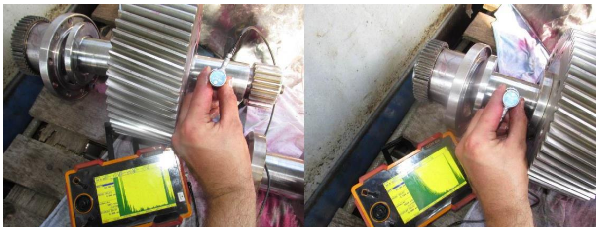
Slika 29. Ispitivanje ležajnih rukavaca kod pogonskog zupčanika [16]
