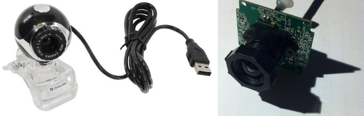
Slika 4. Web-kamera C-090 s kućištem (lijevo) i bez kućišta (desno)
