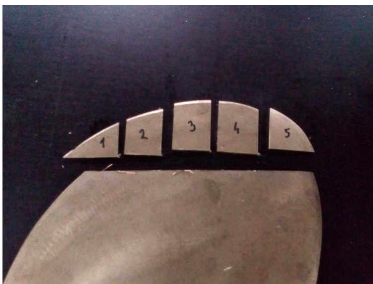
Slika 30. Uzorci za mikrostrukturnu analizu
