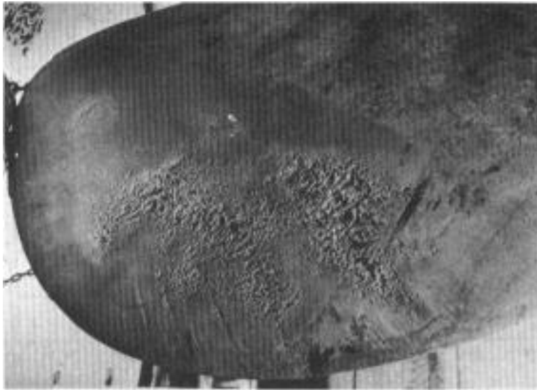
Slika 19. Erozijska krila vijka [3]
