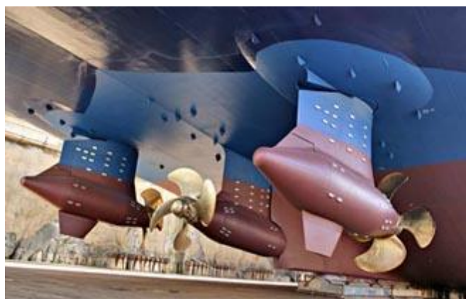
Slika 5. Azipod sustav propulzije [7]
