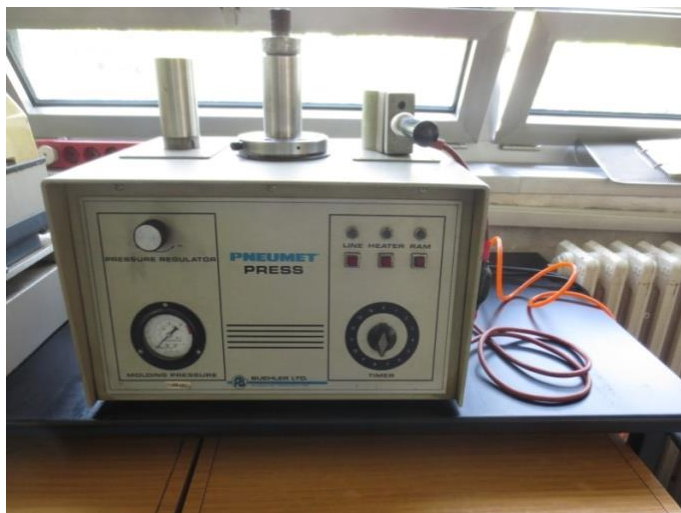
Slika 31. Polimerna preša PneumetPress za zalijevanje uzoraka u polimernu masu
