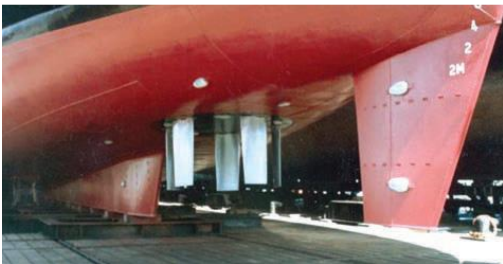
Slika 10. Prikaz krme Voight - Schneiderovog propulzijskog sustava [11]
