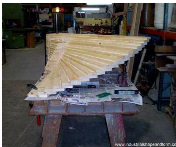
Slika 23. Model broskog vijka od drveta [19]
