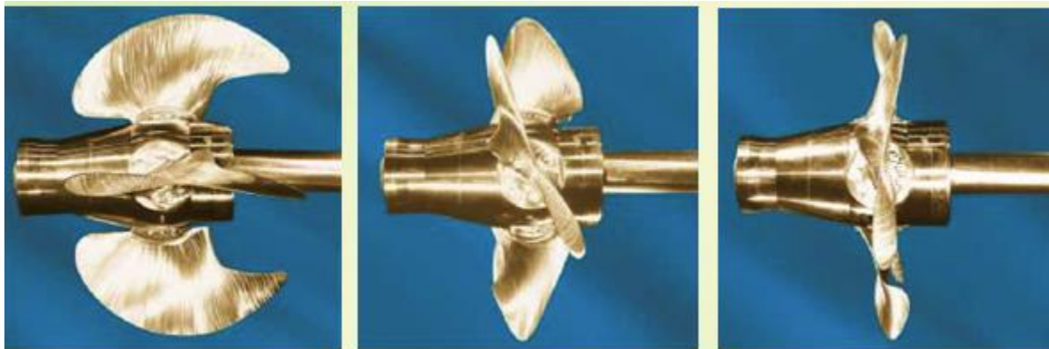
Slika 3. Brodski vijak s promjenjivim usponom krila [5]
