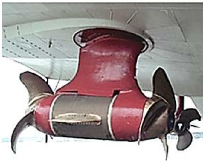
Slika 8. Schottel gondolski propulzor (SEP) [10]
