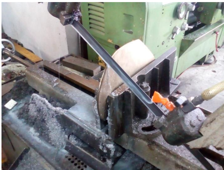
Slika 29. Izrezivanje uzorka tračnom pilom
