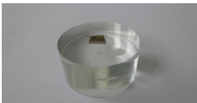
Slika 32. Uzorak zaliven u polimernu masu
