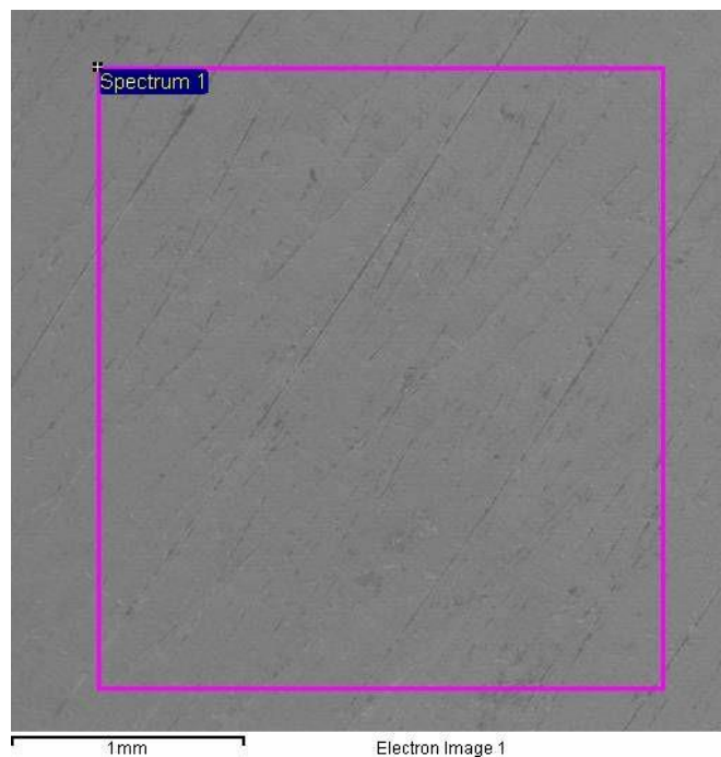
Slika 40. Mjesto ispitivanja kemijskog sastava pomoću EDS-detektora
