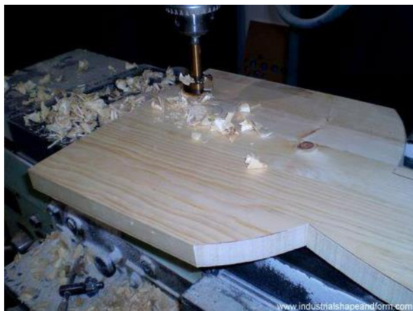
Slika 22. Bušenje rupa u svakom pojedinom segmentu [19]
