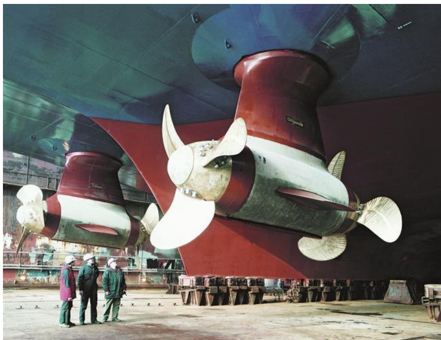
Slika 9. Schottel - Siemens propulzor (SSP) [11]
