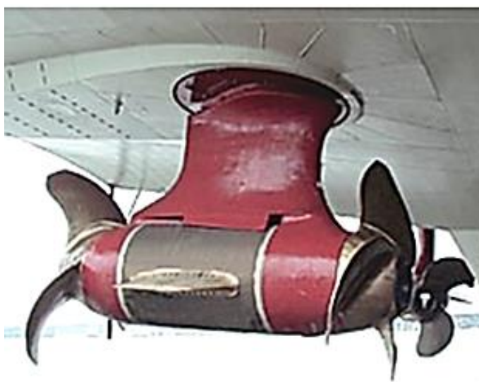
Slika 8. Schottel gondolski propulzor (SEP) [10]
