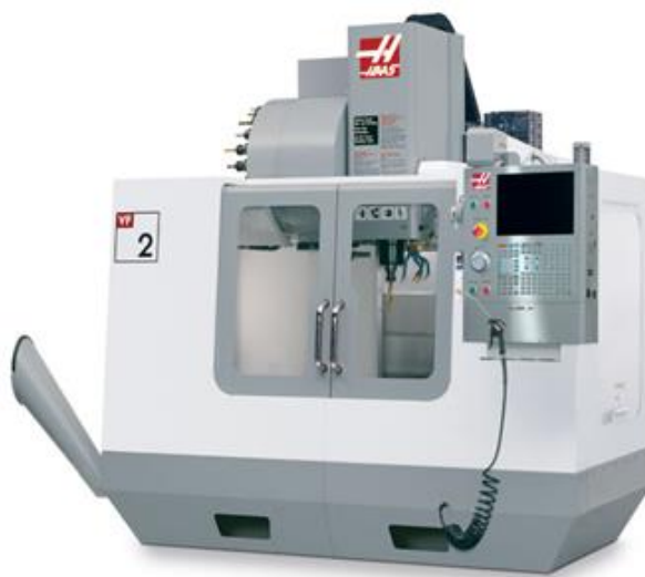
Slika 7. Vertikalni glodaći obradni centar Haas VF2 [10]
