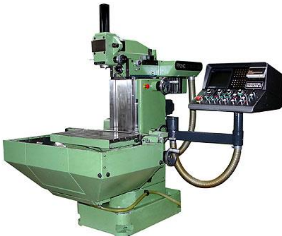
Slika 6. NU glodalica Deckel FP2NC [9]
