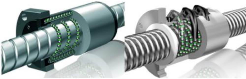
Slika 13. Prikaz unutarnje i vanjske recirkulacije valjnih tijela [15]
