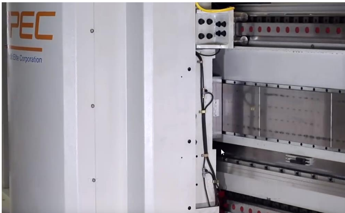
Slika 33. Y- os obradnog centra pokretana linearnim motorom [37]
