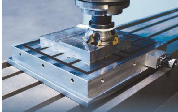
Slika 22. Magnetsko stezanja obratka [20]
