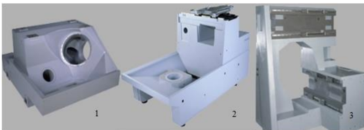
Slika 29. Postolja obradnih strojeva od mineralnog lijeva [30]
