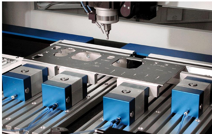
Slika 20. Pneumatska stezna naprava [21]
