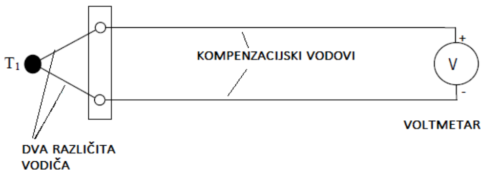
Slika 27. Princip rada termopara [1]
