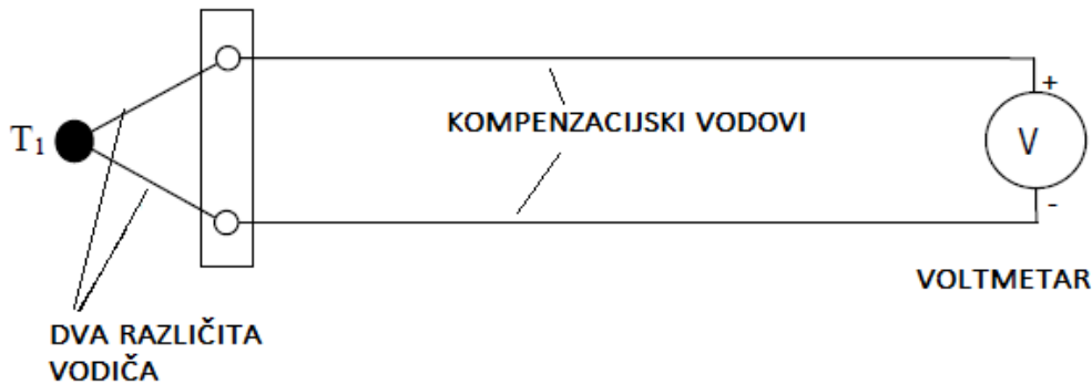
Slika 27. Princip rada termopara [1]
