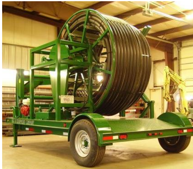
Slika 28. PE cijev u kolutu [35]
