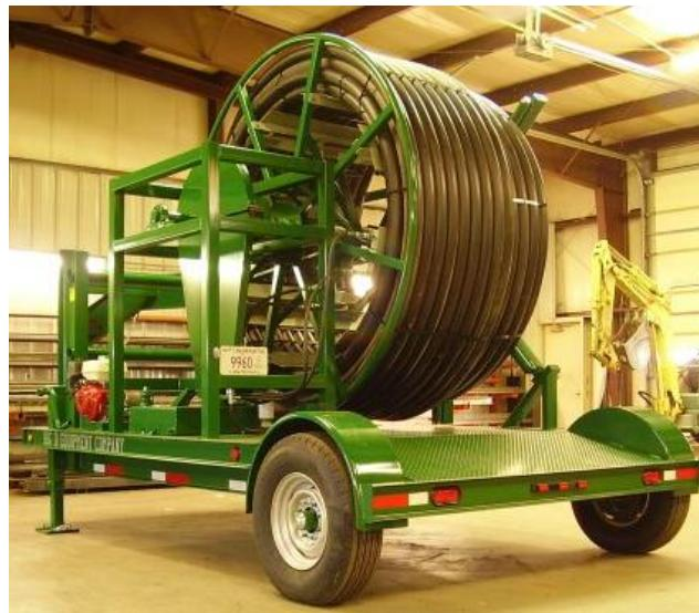
**Slika 28. PE cijev u kolatu [35]**
