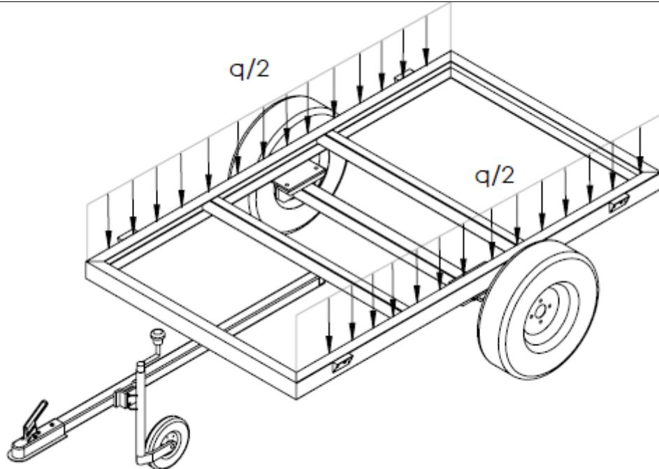
**Slika 7. Opterećenje uzdužnih nosača okvira prikolice**
