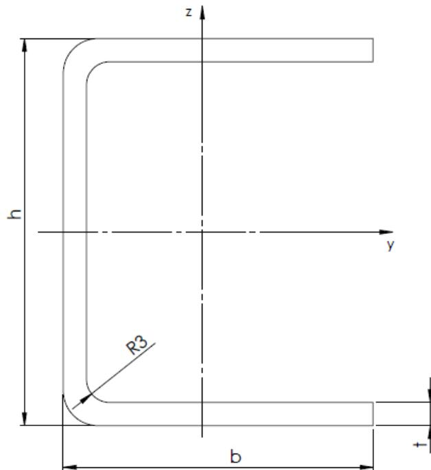
**Slika 13. Profil prednjeg poprečnog nosača**
