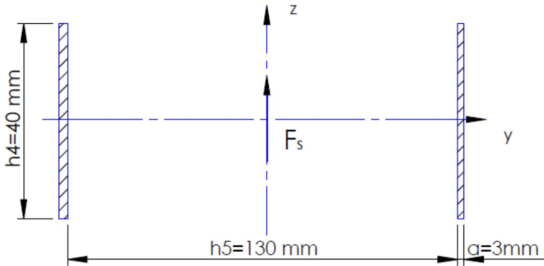
**Slika 20.** Presjek zavara stabilizatora
