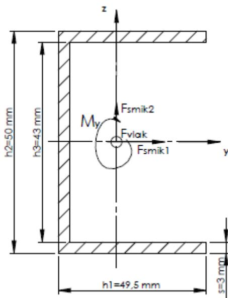
**Slika 16. Presjek zavara spoja poprečnih i uzdužnih U-profila**
