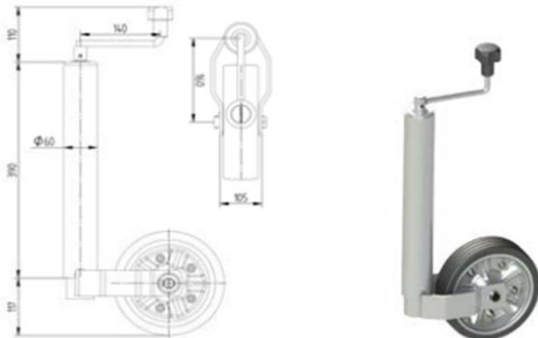
**Slika 32. Izgled i mjerna skica stabilizatora**
