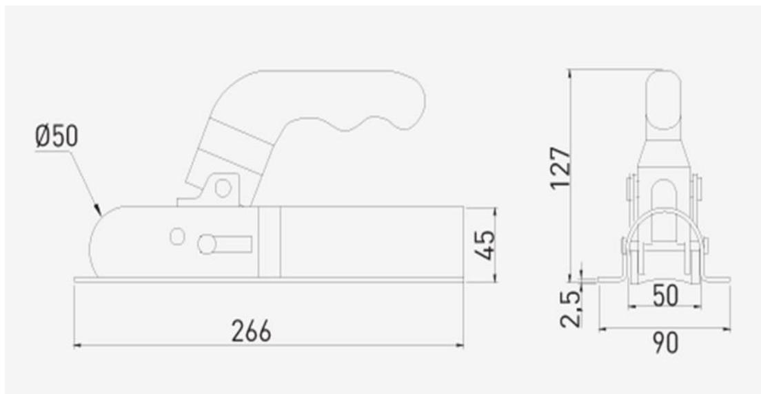
**Slika 31. Mjerna skica vučne spojnica****Tablica 16. Tehničke karakteristike vučne spojnica[16]**
