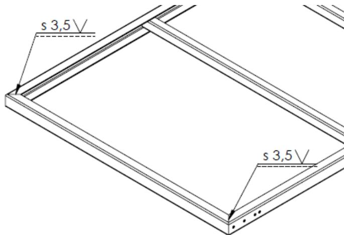
**Slika 15. Prikaz mesta zavara prednjeg poprečnog profila i uzdužnih profila**
