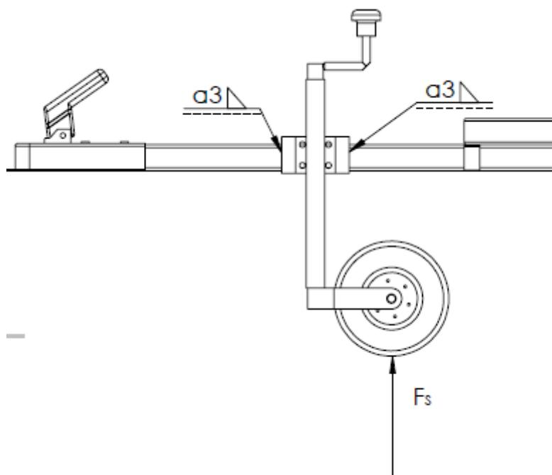
**Slika 19.** Prikaz mesta zavara stabilizatora i ruda
