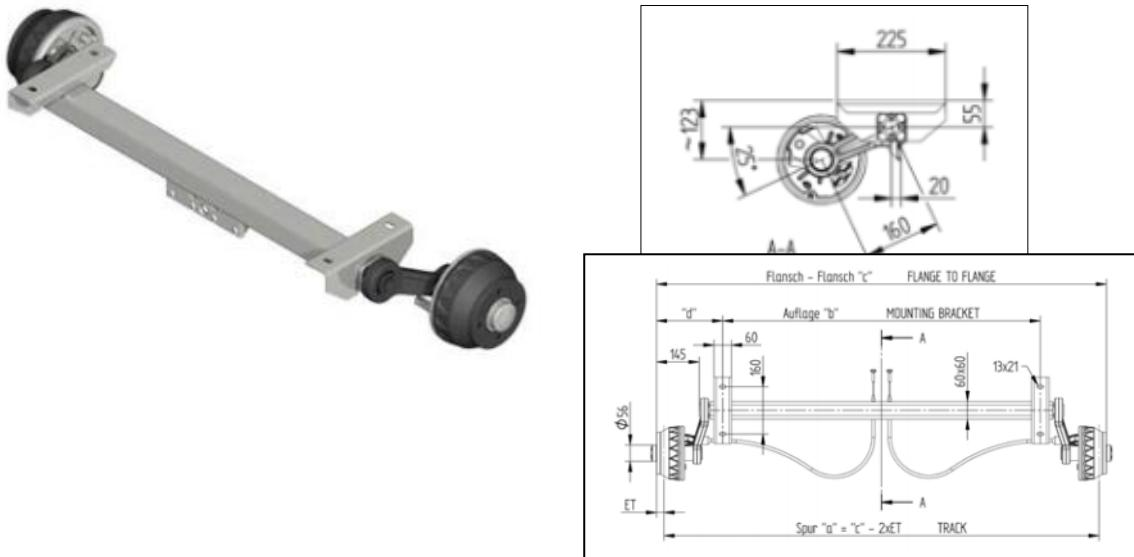
**Slika 28. Mjerna skica i izgled osovine s kočnicom[15]**
