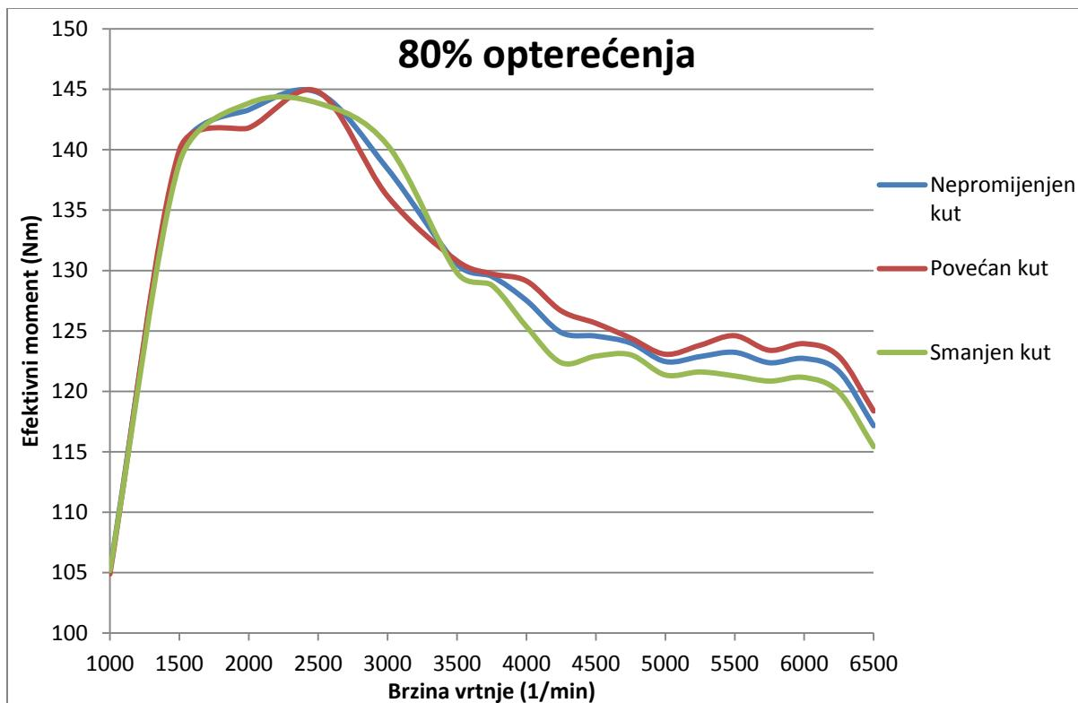
**Slika 28. Promjena efektivnog momenta u ovisnosti o promjeni kuta pretpaljenja na 80% opterećenja**
