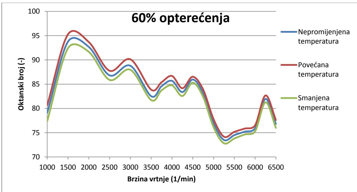
**Slika 47.** Promjena potrebnog oktanskog broja u ovisnosti o promjeni temperature stijenke cilindara na 60% opterećenja
