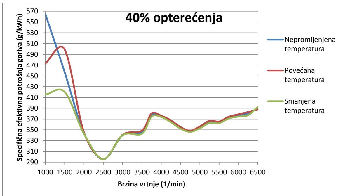
**Slika 51.** Promjena specifične efektivne potrošnje goriva u ovisnosti o promjeni temperature stijenke cilindara na 40% opterećenja
