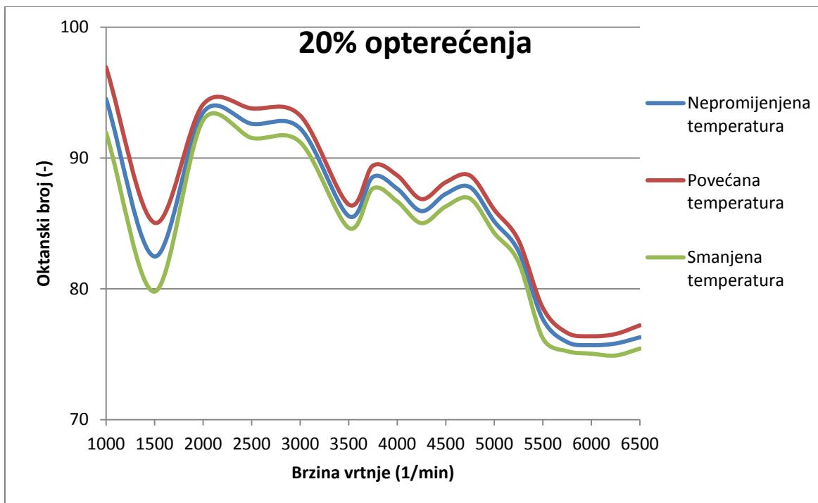
Slika 53. Promjena potrebnog oktanskog broja u ovisnosti o promjeni temperature stijenke cilindara na 20% opterećenja
