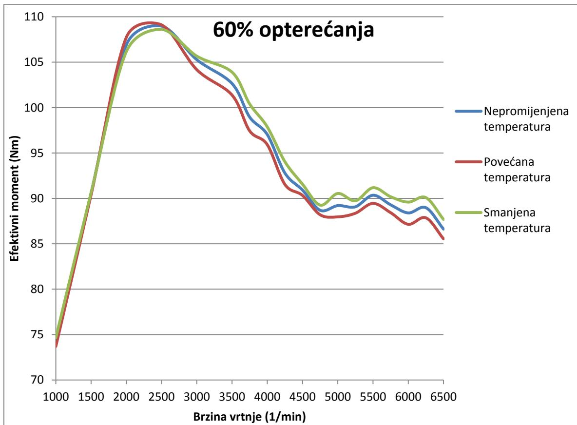
Slika 46. Promjena efektivnog momenta u ovisnosti o promjeni temperature stijenke cilindara na 60% opterećenja
