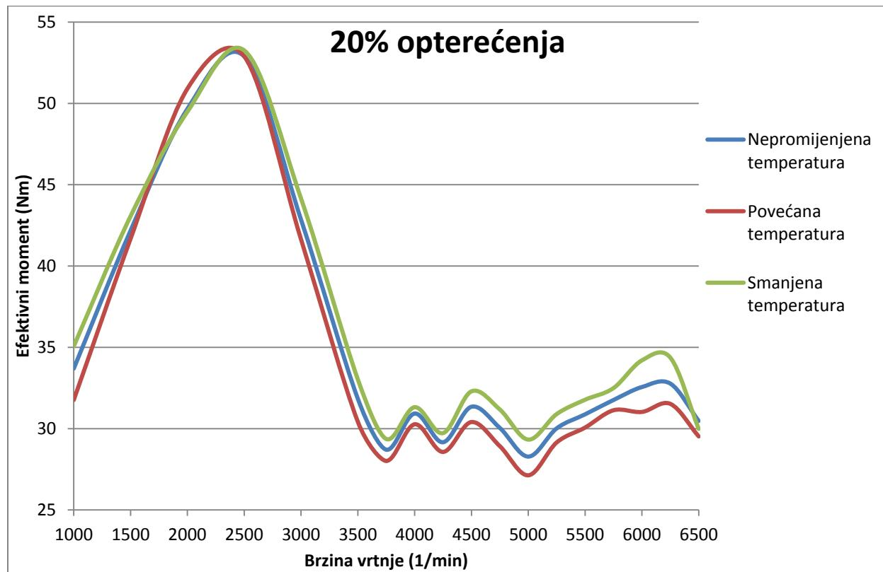
**Slika 52.** Promjena efektivnog momenta u ovisnosti o promjeni temperature stijenke cilindara na 20% opterećenja
