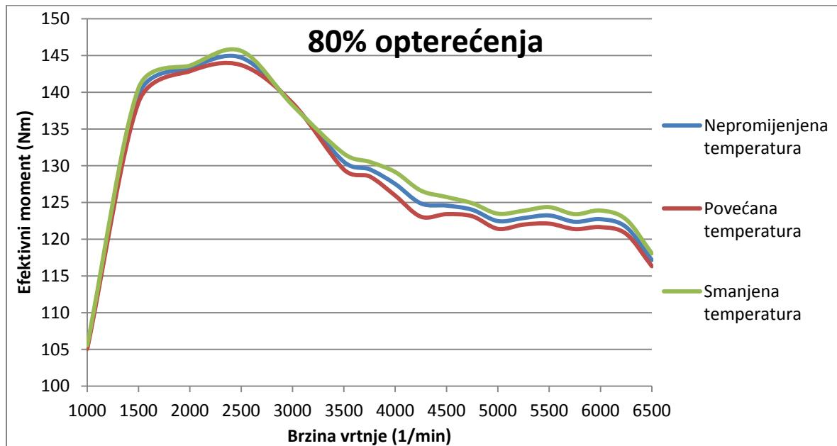
**Slika 43. Promjena efektivnog momenta u ovisnosti o promjeni temperature stijenke cilindara na 80% opterećenja**
