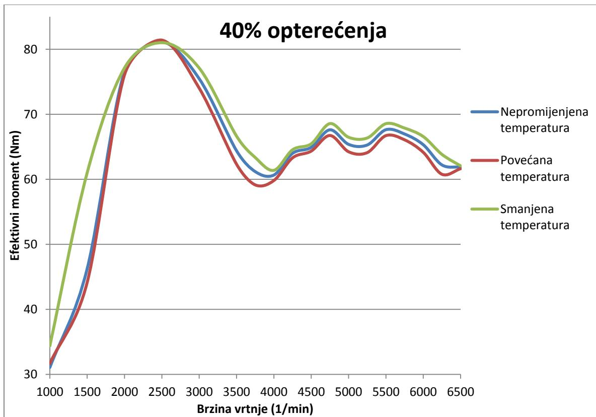
**Slika 49.** Promjena efektivnog momenta u ovisnosti o promjeni temperature stijenke cilindara na 40% opterećenja
