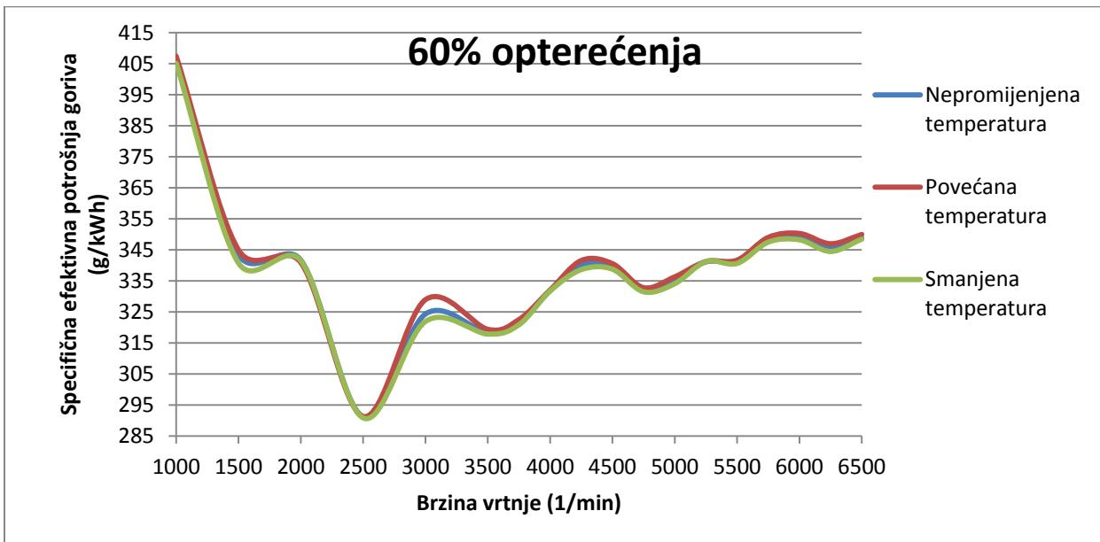
**Slika 48.** Promjena specifične efektivne potrošnje goriva u ovisnosti o promjeni temperature stijenke cilindara na 60% opterećenja
