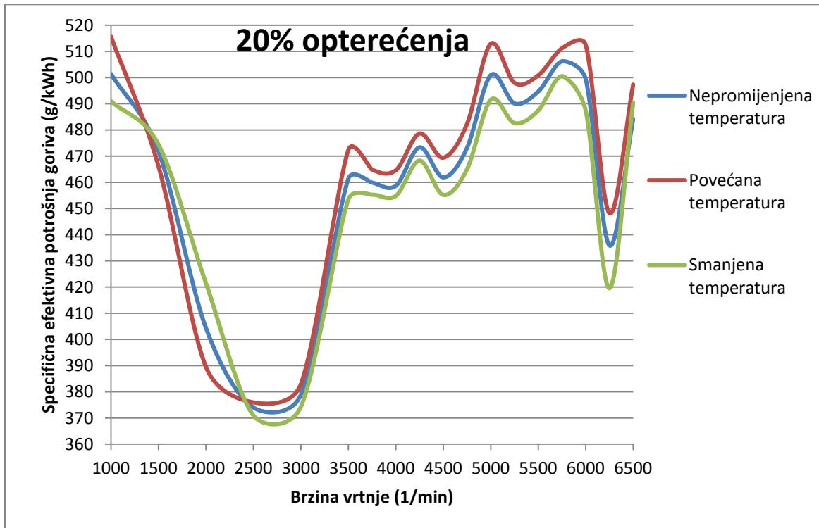
Slika 54. Promjena specifične efektivne potrošnje goriva u ovisnosti o promjeni temperature stijenke cilindara na 20% opterećenja
