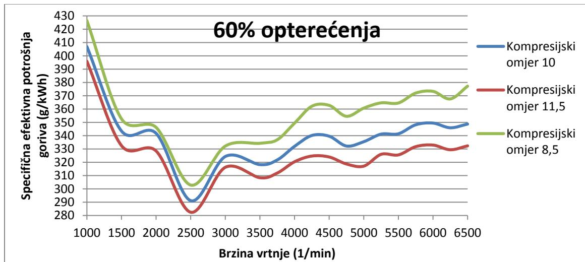
Slika 18. Promjena specifične efektivne potrošnje goriva u ovisnosti o kompresijskom omjeru na 60% opterećenja
