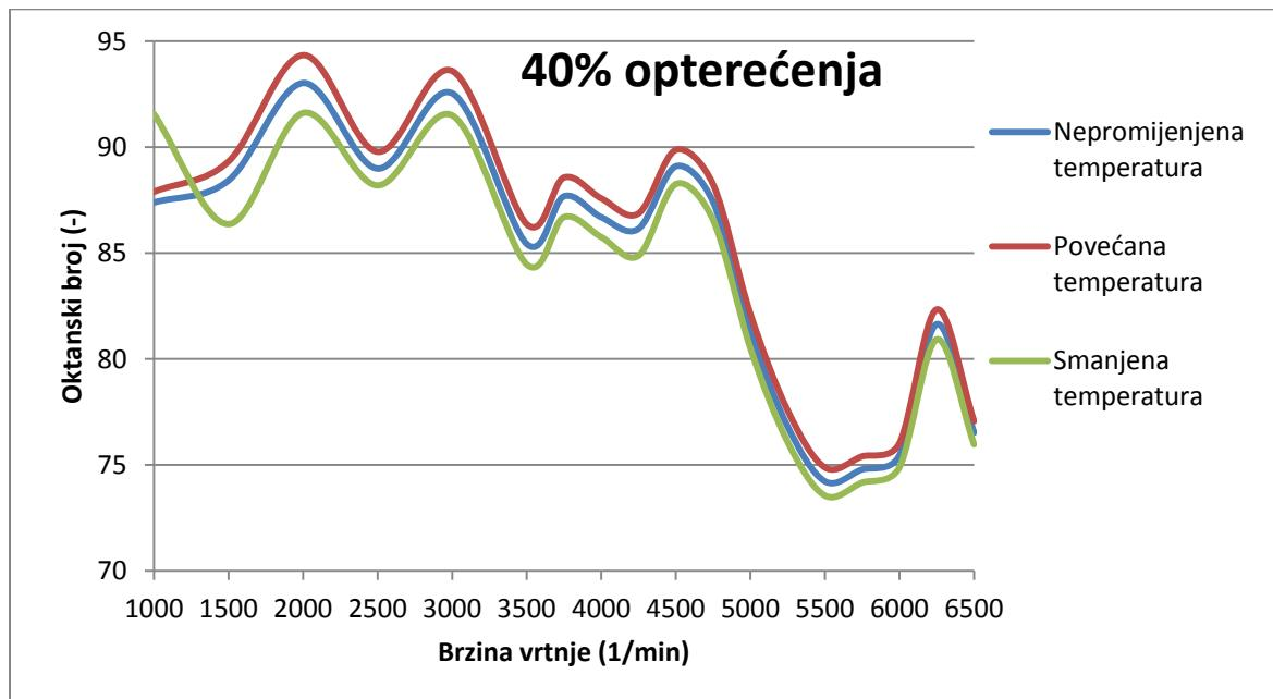
**Slika 50.** Promjena potrebnog oktanskog broja u ovisnosti o promjeni temperature stijenke cilindara na 40% opterećenja
