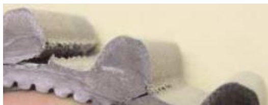
Slika 27. Pukotina u korijenu zuba [8]
