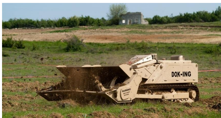
Slika 3. Razminiranje strojem (DOK-ING MV-4) [18]
