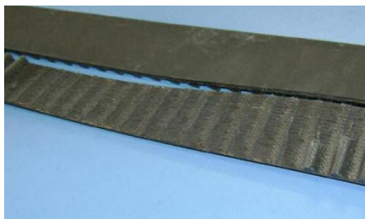
Slika 28. Odrez zuba zupčastog remena [8]
