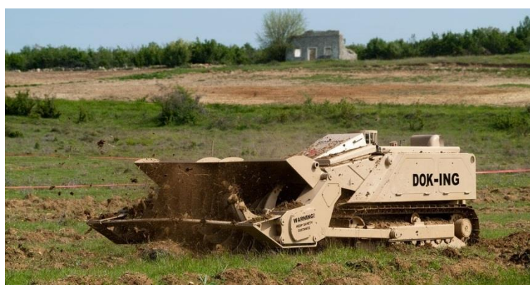
Slika 3. Razminiranje strojem (DOK-ING MV-4) [18]
