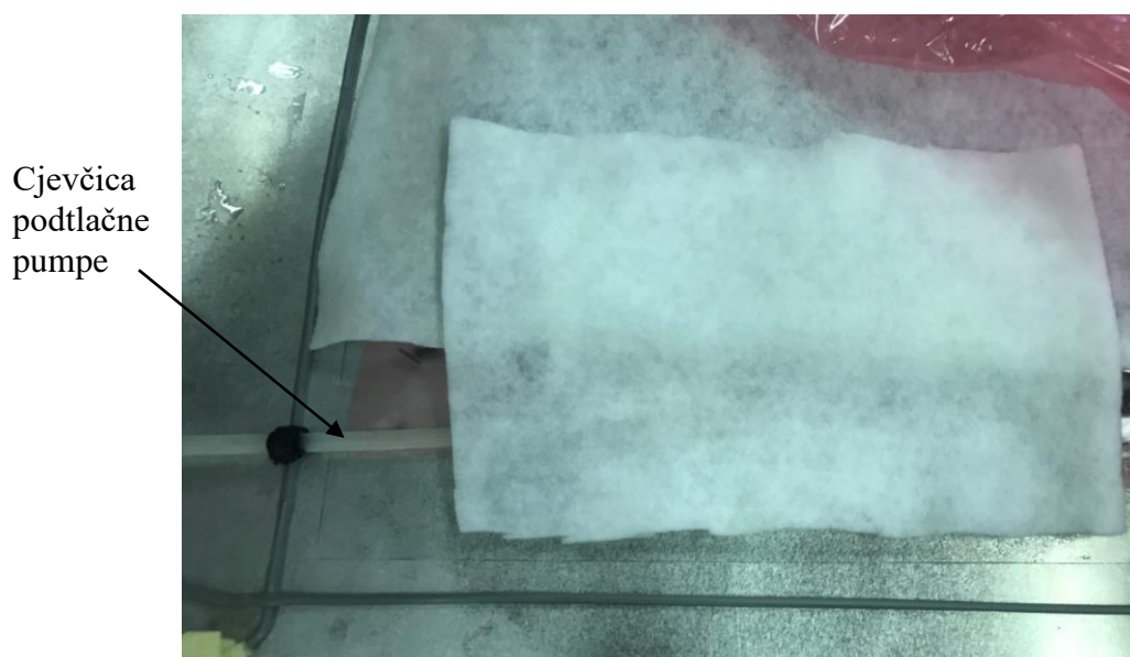
Slika 48. Postavljanje cjevčice podtlačne pumpe
