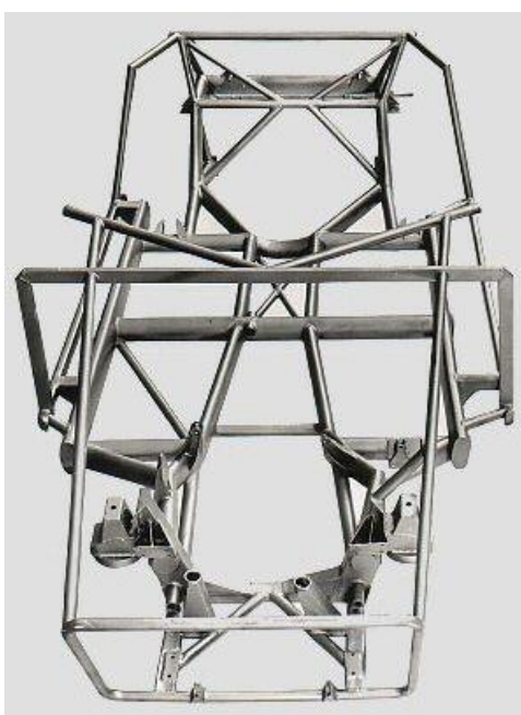
Slika 5. Višecijevna šasija modela Maserati Alfieri [5]
