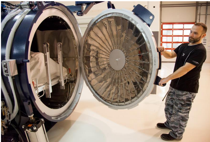
Slika 14. Autoklav tvrtke Rimac Automobili [15]
