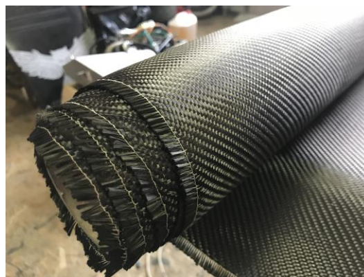
Slika 30. Ugljična vlakna tvrtke TeXtreme ®
