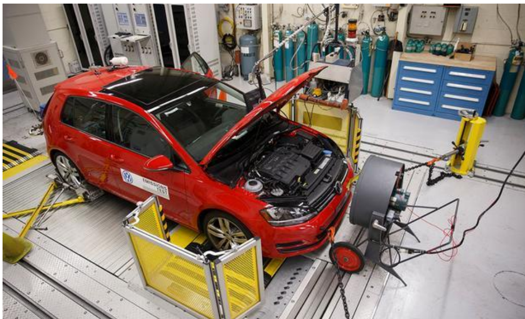
Slika 1. Mjerenje emisija vozila
