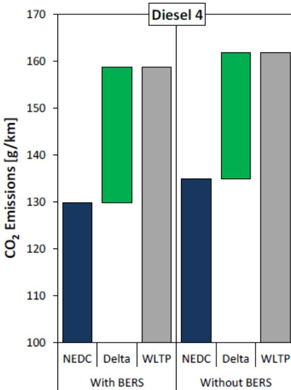
Usporedba emisije CO<sub>2</sub> sa primjenom i bez primjene sustava rekuperacije energije kočenja (eng. *Brake Energy Recuperation System*). Iz rezultata se može vidjeti manja emisija sa primjenom sustava rekuperacije energije kočenja .
