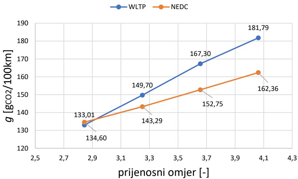
**Slika 39.** Utjecaj promjene prijenosnog omjera osovinske redukcije na emisiju CO<sub>2</sub>
