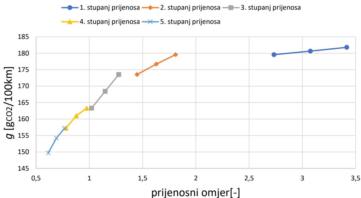
**Slika 40.** Utjecaj promjene prijenosnih omjera stupnjeva prijenosa na emisiju CO<sub>2</sub>
