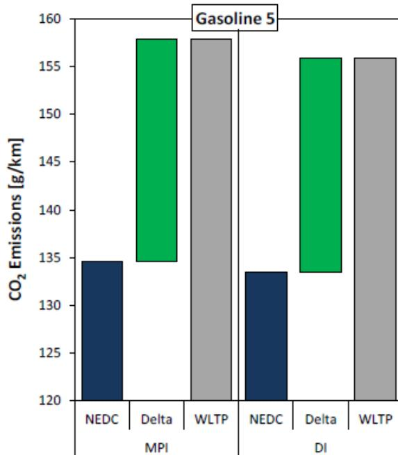
Usporedba emisije CO<sub>2</sub> sa sustavom direktnog ubrizgavanja goriva (eng. *Direct Injection*) i sustavom pojedinačnog ubrizgavanja goriva (eng. *Multi Point Injection*). Iz rezultata se može vidjeti nešto manja emisija sa primjenom sustava direktnog ubrizgavanja goriva.
