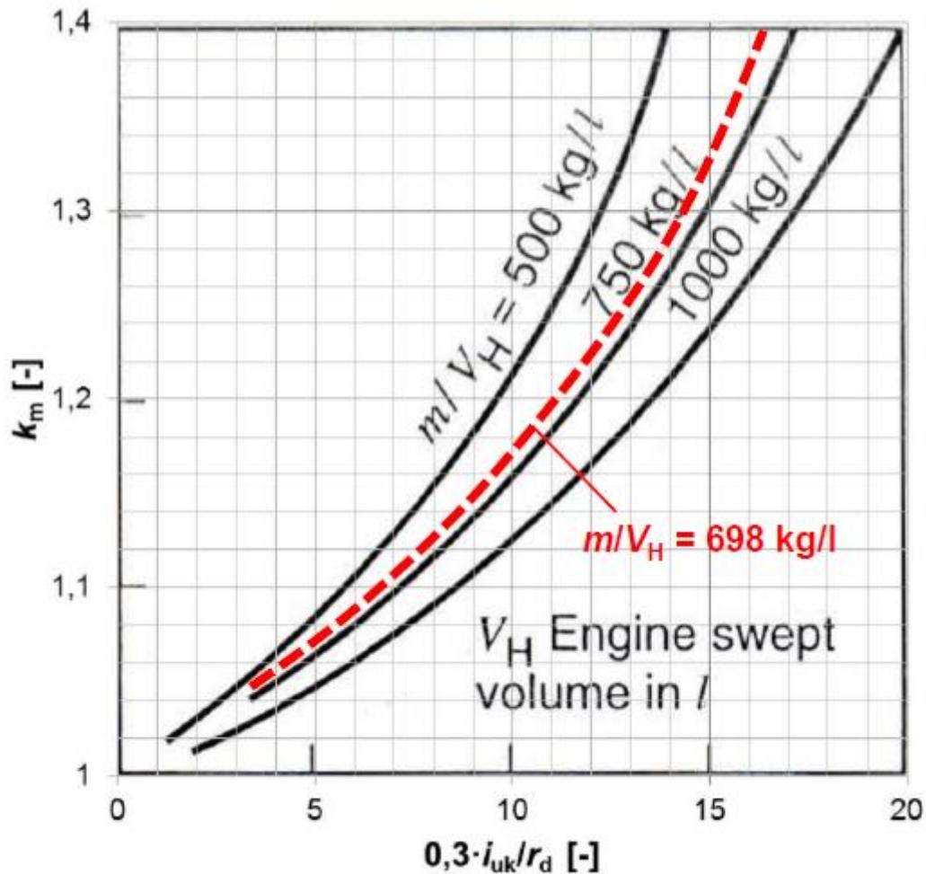
Slika 14. Dijagram za određivanje faktora rotirajućih masa
