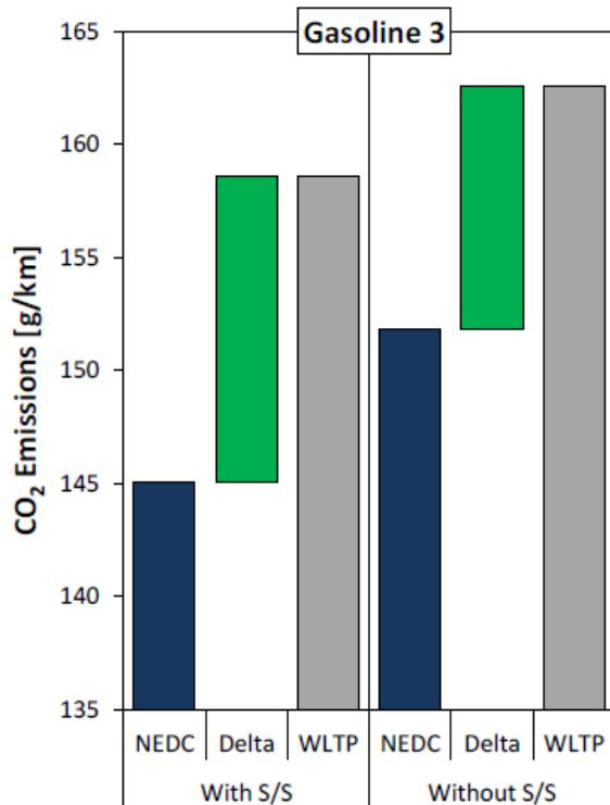
Usporedba emisije CO<sub>2</sub> s uključenim i isključenim Start/Stop (eng. *Start/Stop*) sustavom gdje se može vidjeti značajno veća emisija CO<sub>2</sub> sa isključenim Start/Stop sustavom.
