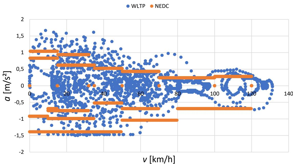
**Slika 31.** Ubrzjanje u ovisnosti o brzini vozila kod WLTP i NEDC ispitnih ciklusa
