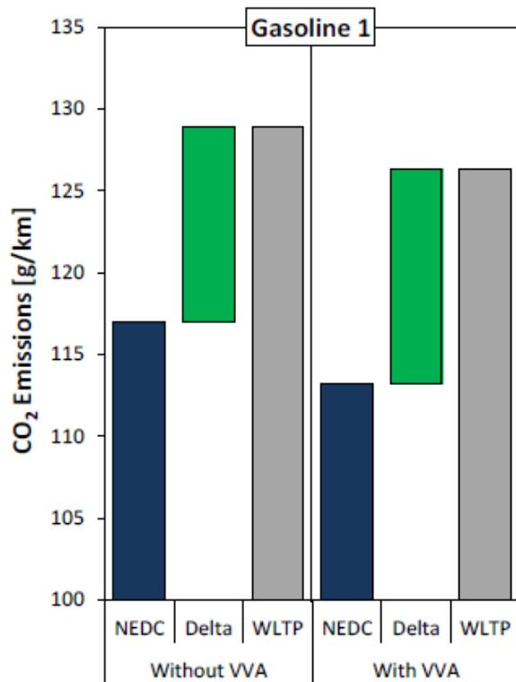
Usporedba emisije CO<sub>2</sub> s primjenom i bez primjene sustava promjenjivog pokretanja ventila (eng. *Variable Valve Actuation*). Iz rezultata se može vidjeti manja emisija sa primjenom sustava promjenjivog pokretanja ventila..
