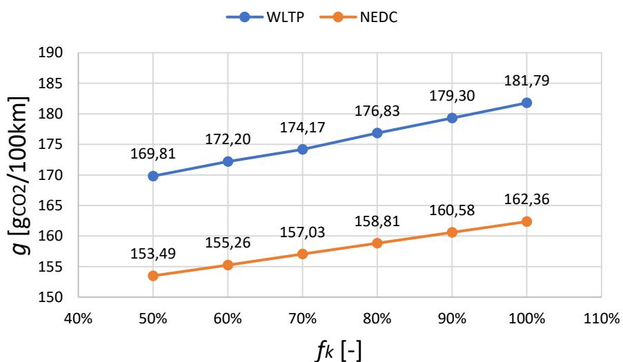
**Slika 38.** Utjecaj promjene faktora otpora kotrljanja na emisiju CO<sub>2</sub>
