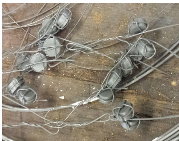
Slika 15. Nitrokarburirani ispitni uzorci vezani u grozdove
