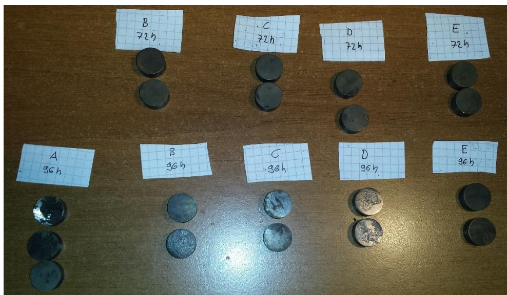
Slika 19. Ispitni uzorci nakon čišćenja od oksida
