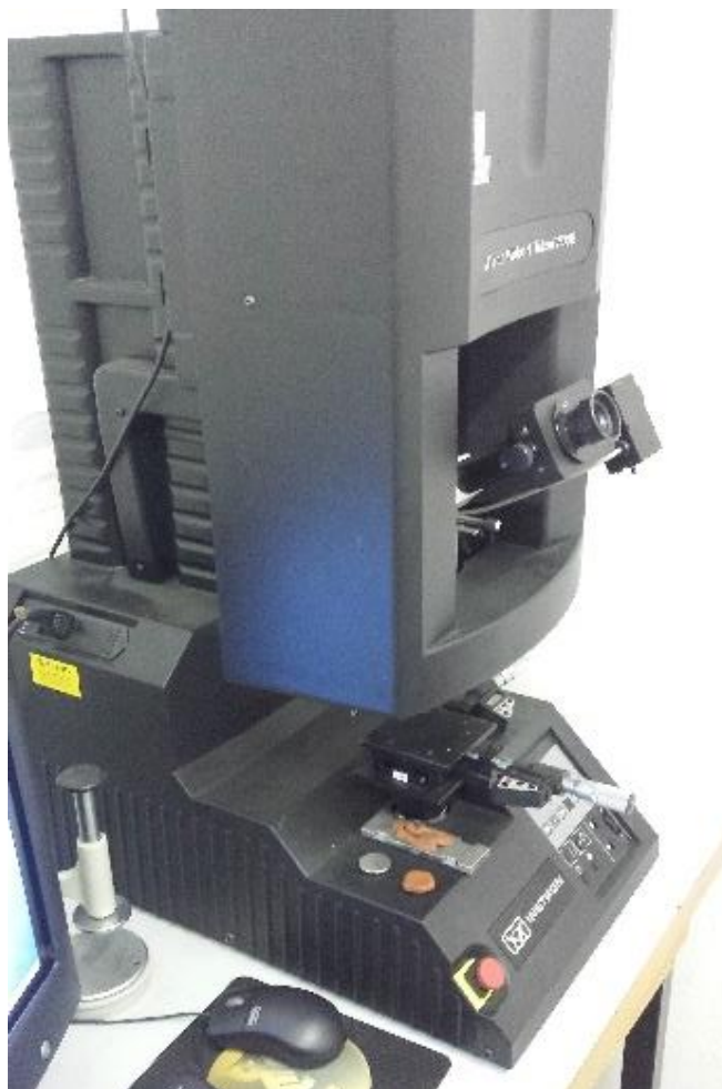
Slika 36. Mikrotvrdomjer Instrom Tukon 2010B
