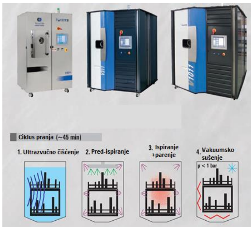
Slika 5. Jedinice za čišćenje i ciklus pranja [7]
