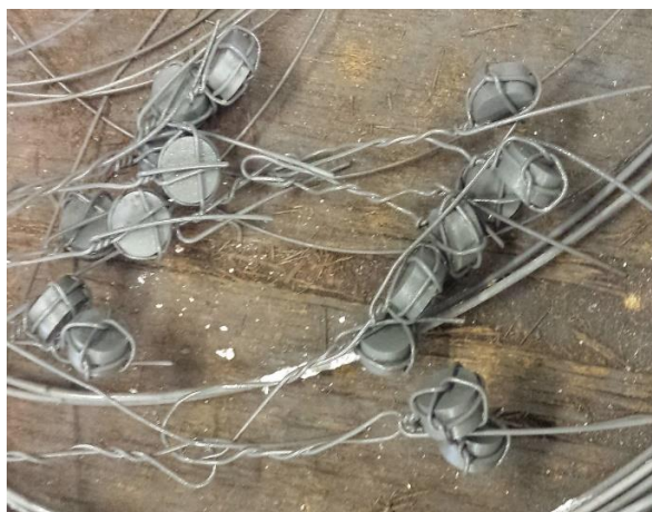
Slika 15. Nitrokarburirani ispitni uzorci vezani u grozdove
