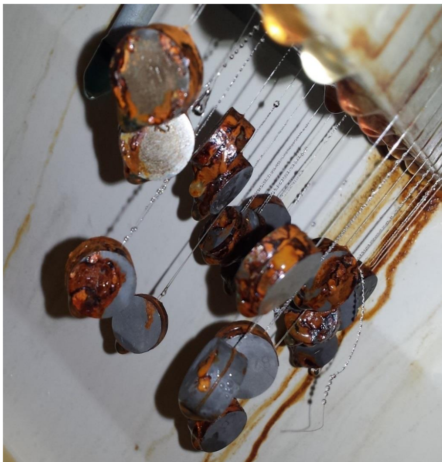
Slika 17. Ispitivanje korozivne postojanosti u slanoj komori
