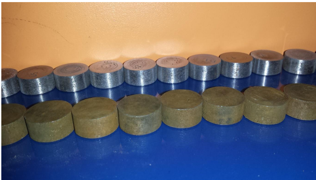
Slika 10. Ručno brušeni ispitni uzorci i ispitni uzorci nakon kemijskog čišćenja
