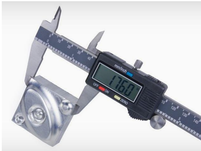
Slika 1 Prikaz mjerenja modernim digitalnim pomičnim mjerilom [2]
