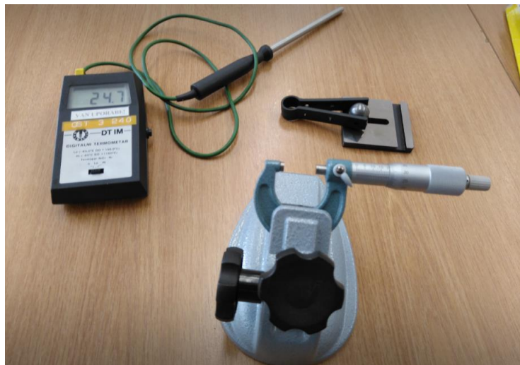
Slika 14 Prikaz mikrometra, predmeta mjerenja i termometra
