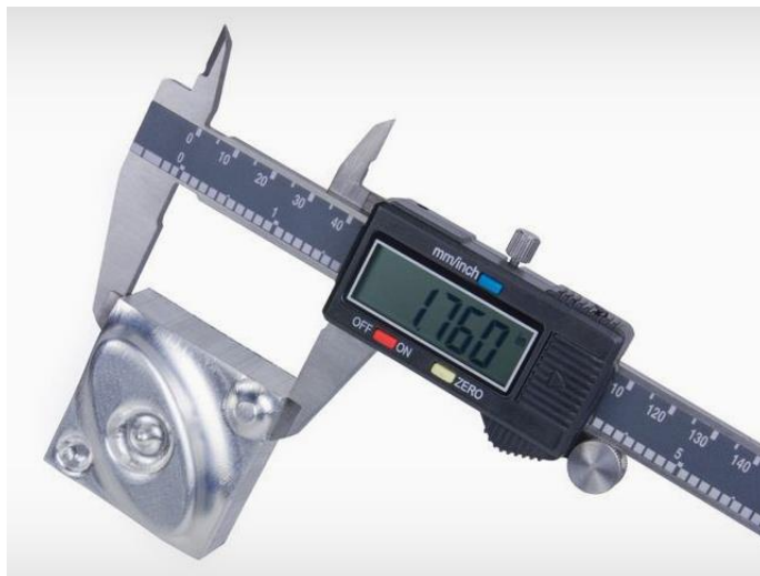
Slika 1 Prikaz mjerenja modernim digitalnim pomičnim mjerilom [2]
