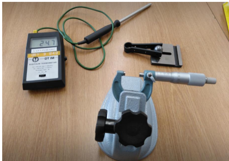
Slika 14 Prikaz mikrometra, predmeta mjerenja i termometra
