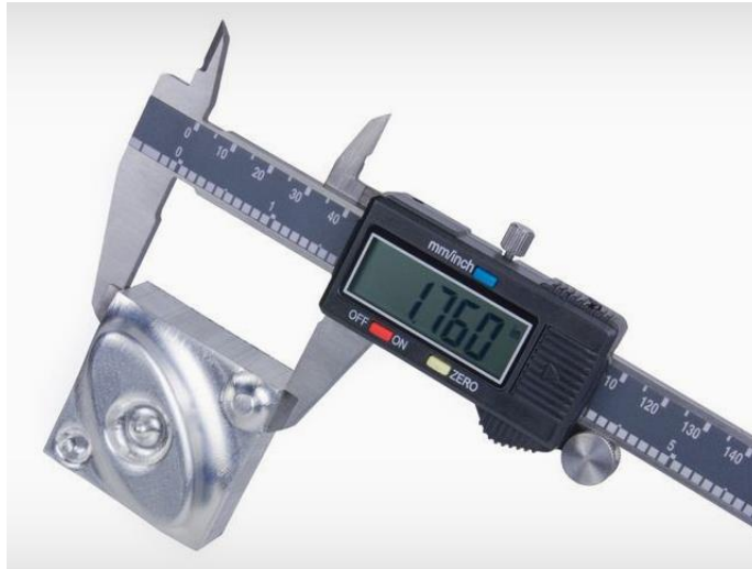
Slika 1 Prikaz mjerenja modernim digitalnim pomičnim mjerilom [2]
