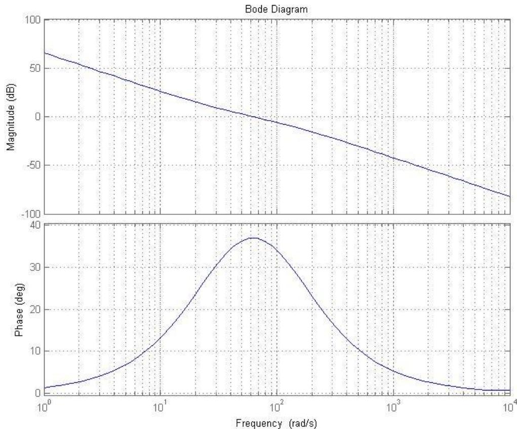
**Slika 52 Bodeovi dijagrami otvorenog regulacijskog kruga podešenog prema simetičnom optimumu**
