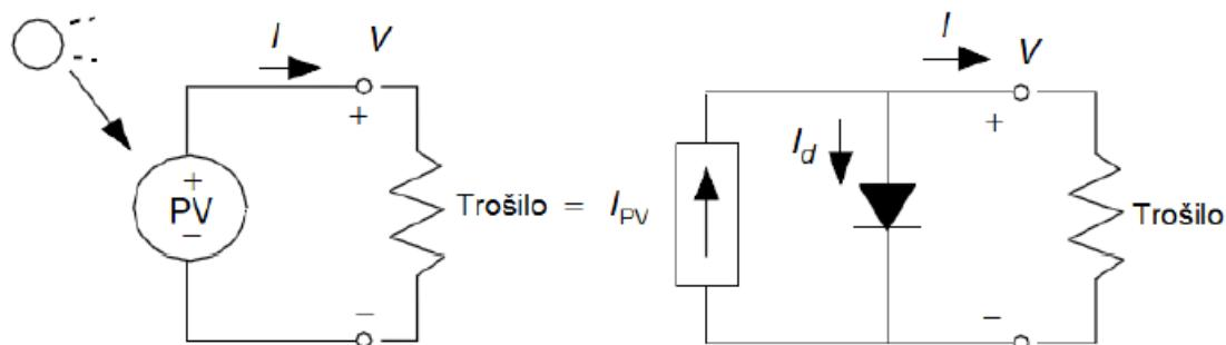
Slika 30 Ekvivalentni električni strujni krug fotonaponske ćelije
