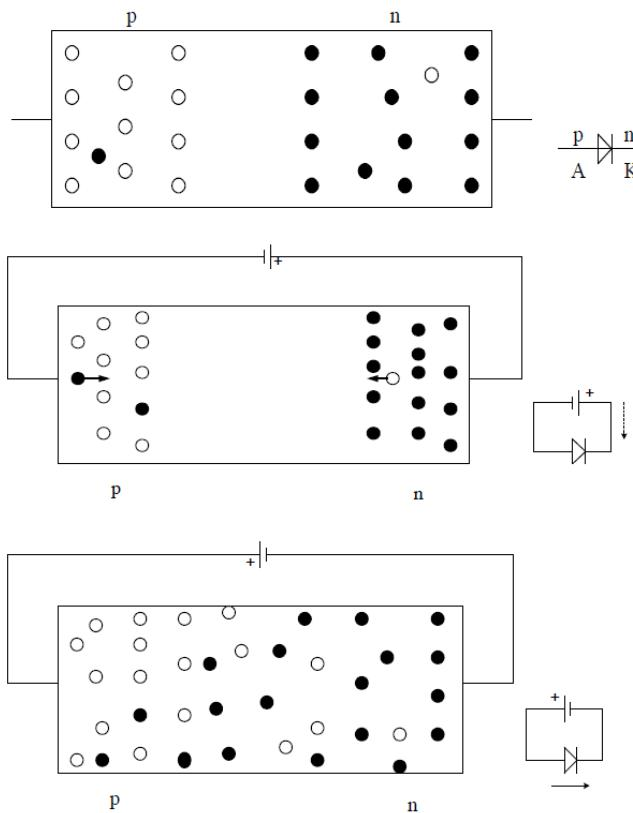
Slika 24 Dioda - zaporni spoj i propusni spoj
