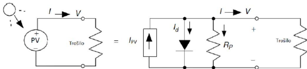
Slika 34 Ekvivalentna električna shema FN čelije s paralelnim parazitskim otporom
