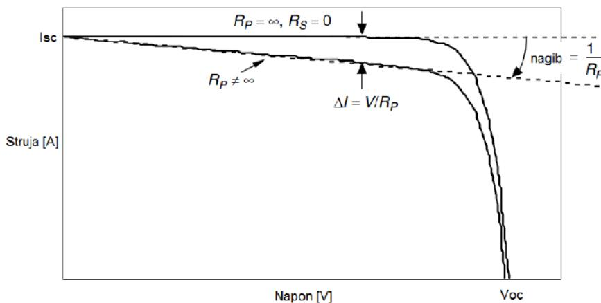
Slika 35 Utjecaj paralelnog parazitskog otpora na I-U karakteristiku FN čelije
