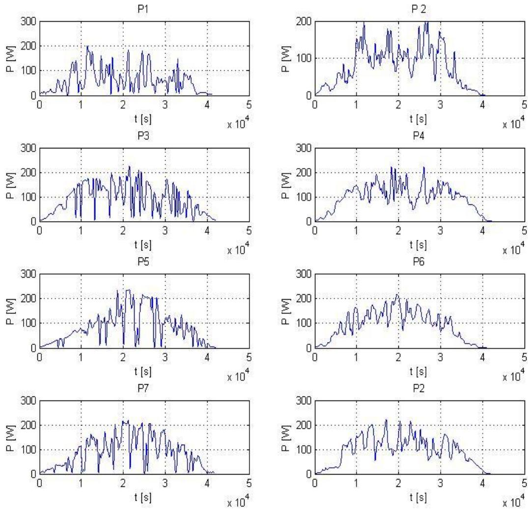
Slika 39 Profili snaga fotonaponske ćelije
