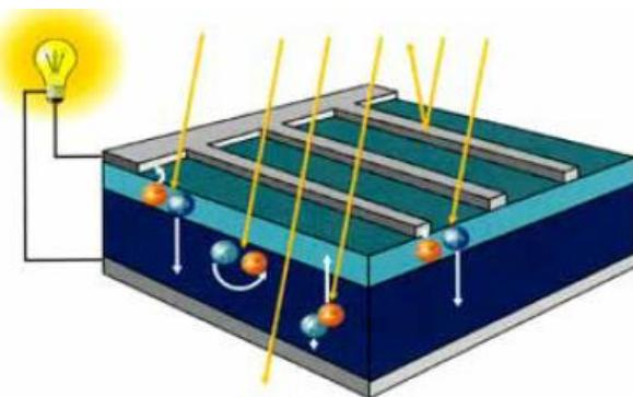
Slika 26 Nastanak parova elektrona i šupljina u solarnoj ćeliji
