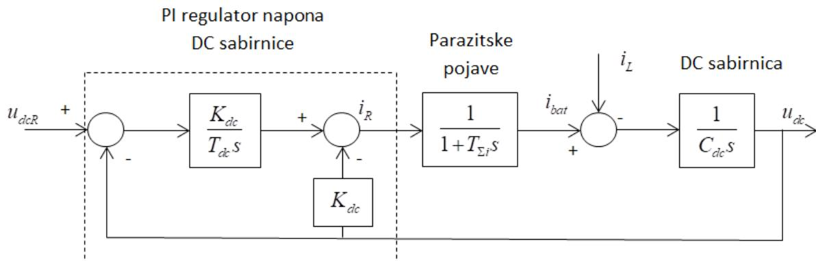
Slika 47 Pojednostavljeni model regulacije napona DC sabirnice
