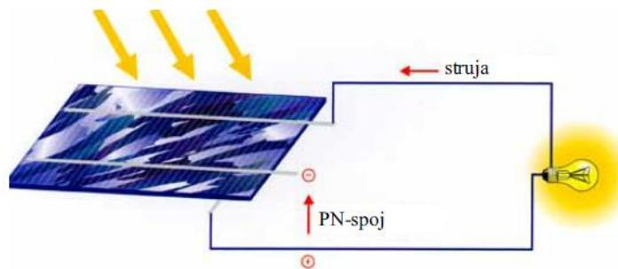
Slika 27 Solarna ćelija kao izvor električne energije
