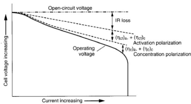
Slika 10 Strujno naponska karakteristika čelije
