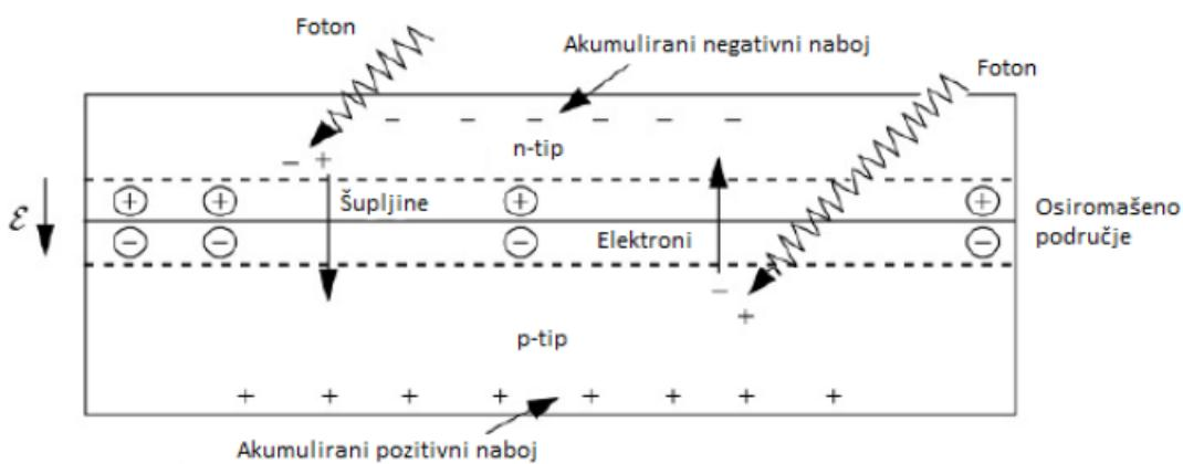
Slika 23 Osnovni prikaz p-n spoja fotonaponske čelije
