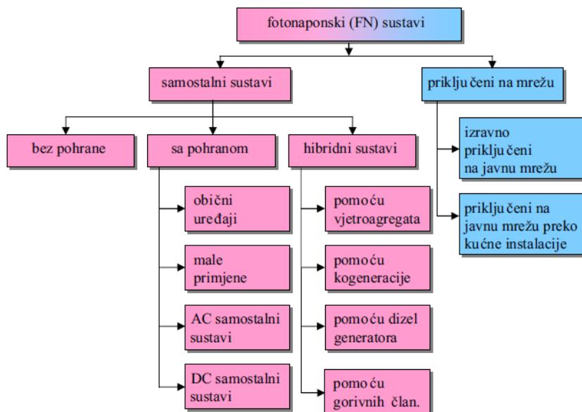
Slika 28 Podjela fotonaponskih sustava
