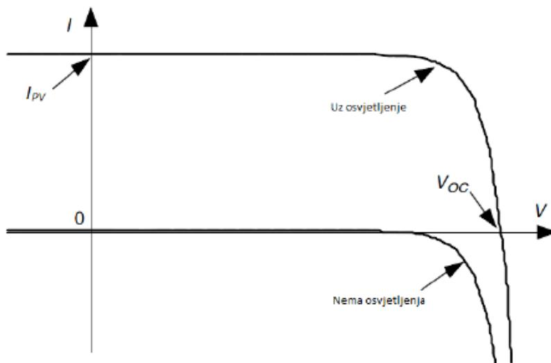
Slika 31 I-U karakteristika fotonaponske čelije sa i bez osvjetljenja
