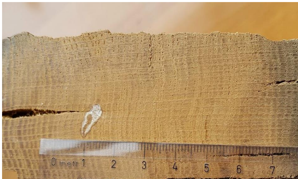
Slika 23. Makrostruktura poprečnog presjeka subfosilnog hrasta (uzorak 2)
