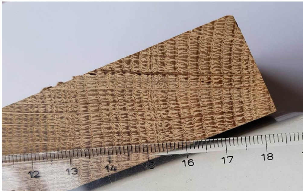
Slika 21. Makrostruktura poprečnog presjeka recentnog hrasta (uzorak 0)
