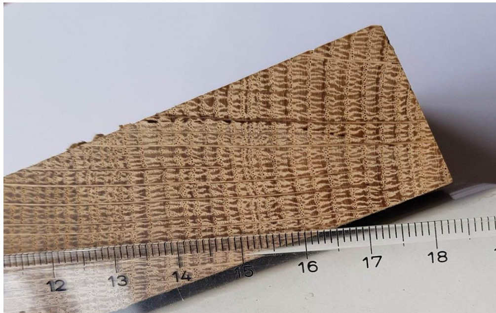
Slika 21. Makrostruktura poprečnog presjeka recentnog hrasta (uzorak 0)
