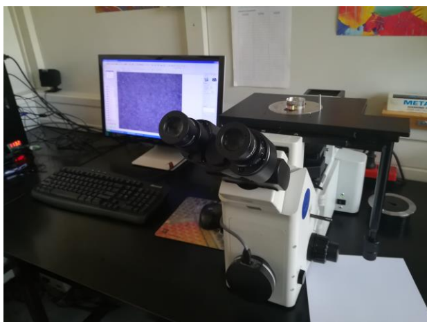
Slika 6. 7. Svjetlosni mikroskop Olympus GX51 i uzorak zaliven u polimernu masu
