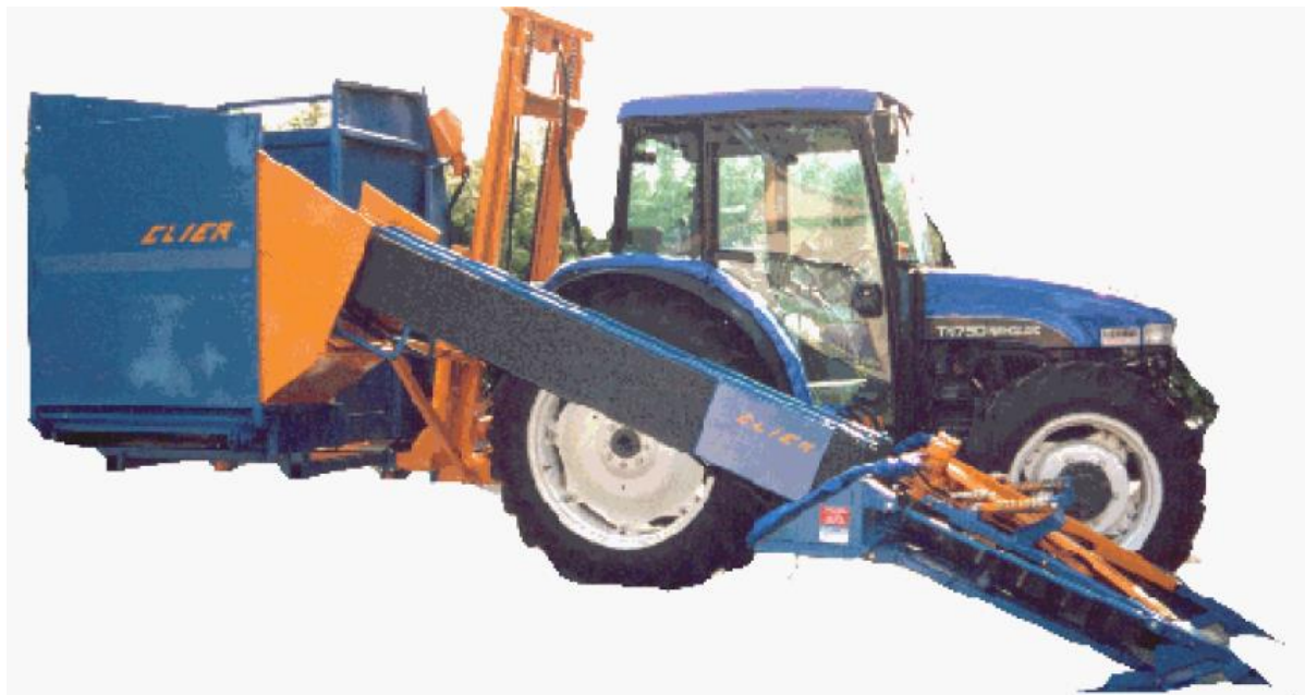
Slika 12. CLIER berač lavande u sklopu s traktorom
