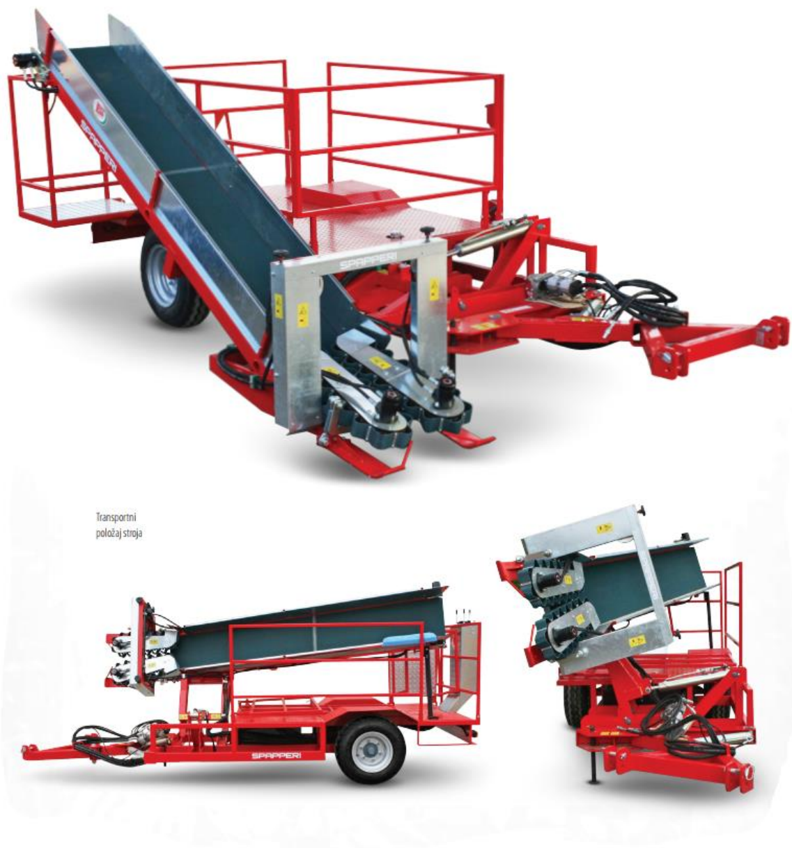
Slika 7. MASSIS - MK 100, traktorski berač aromatičnih biljaka
