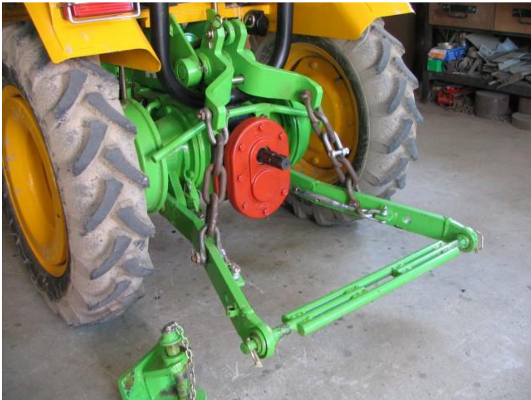
Slika 17. TV-420 izlazno vratilo i poteznica
