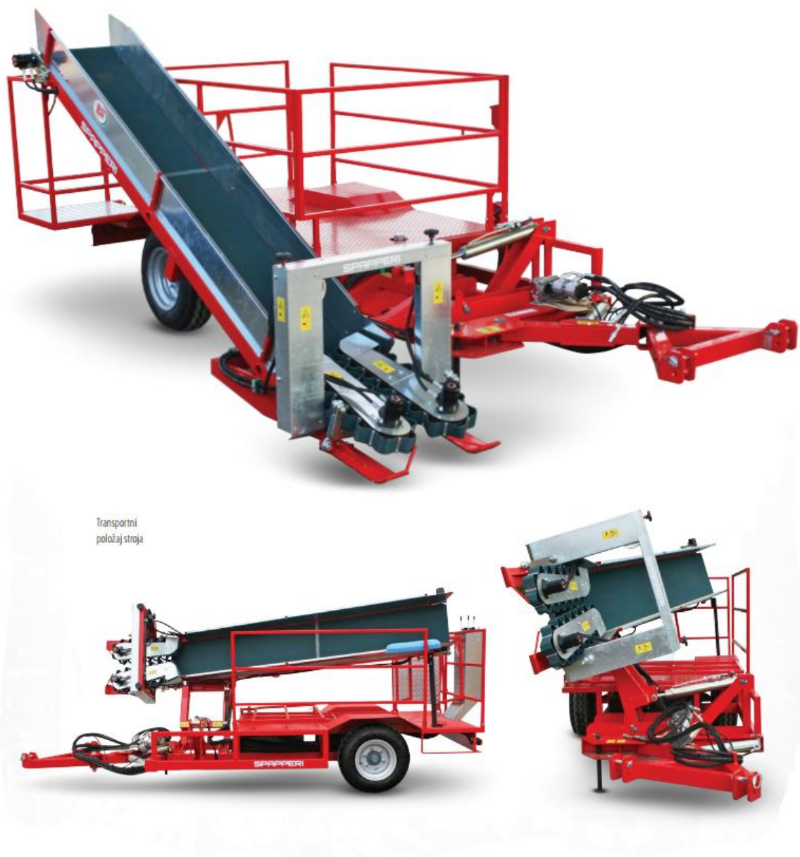
Slika 7. MASSIS - MK 100, traktorski berač aromatičnih biljaka
