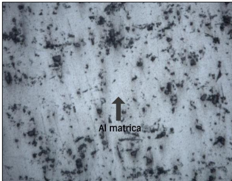
Slika 25. Al matrica s 10 % vol. SiC-a [31]
