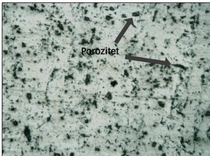
Slika 26. Al matrica s 20 % vol. SiC-a [31]
