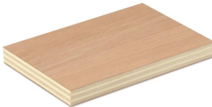
Slika 5. Šperploča - primjer strukturnog kompozita [5]
