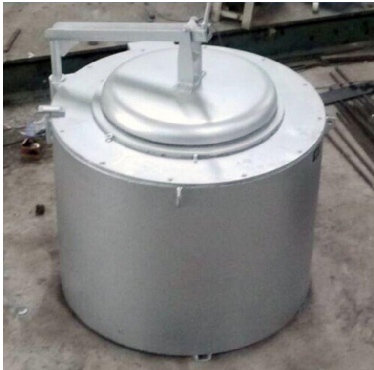
Slika 22. Elektrootporna peć za taljenje metala [27]
