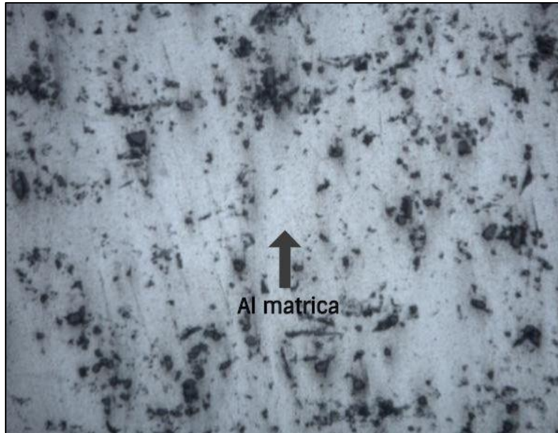
Slika 25. Al matrica s 10 % vol. SiC-a [31]
