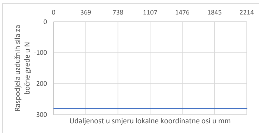
Slika 51. Raspodjela unutarnjih normalnih sila za bočne grede u N
