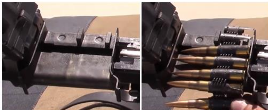
Slika 18. Umetanje metaka u MG-34
