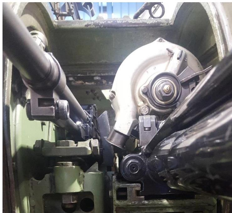
**Slika 14. Prikaz montiranog uređaja za punjenje topa**
