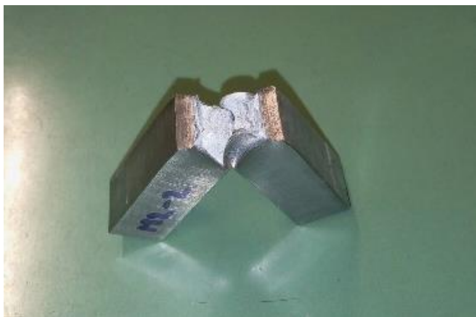
Slika 26. Prikaz žilavog loma na epruvete M2-2
