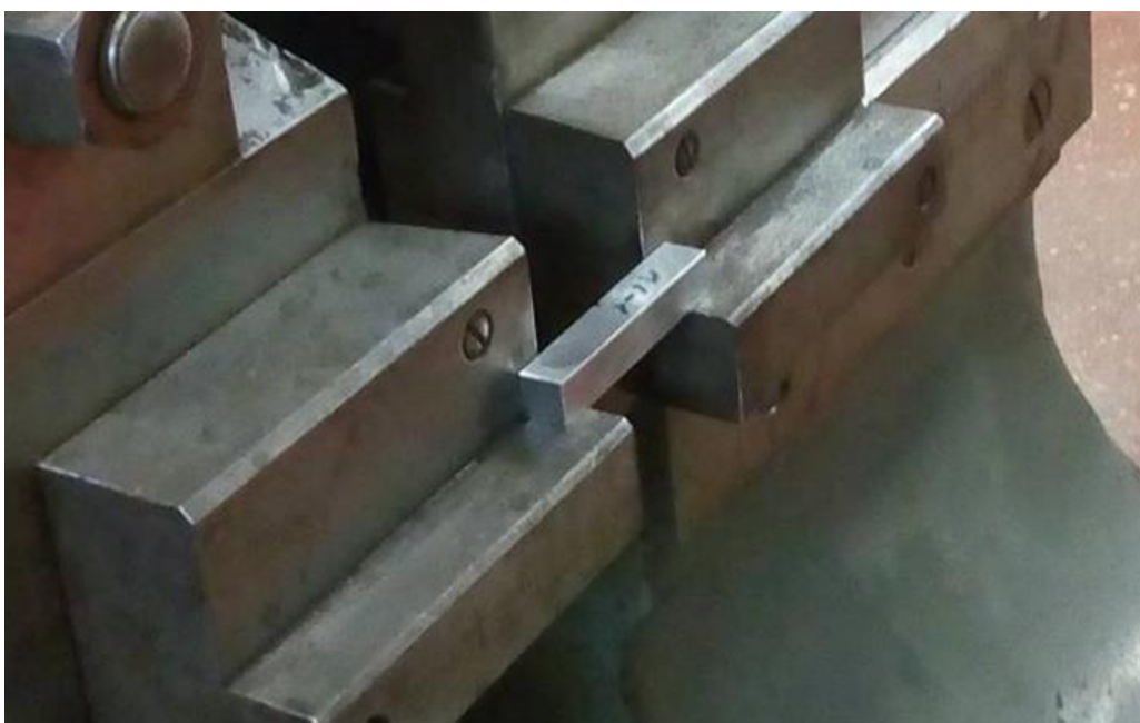
Slika 25: Postavljena epruveta na oslonce Charpy bata
