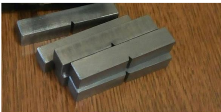
Slika 17. Epruvete s već napravljenim V-zarezom
