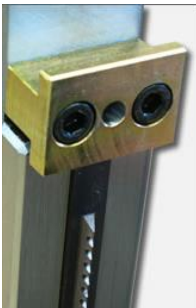
Slika 19. Zubi uređaja za izradu V-zareza
