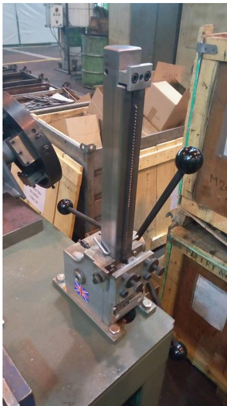
Slika 18. Uređaj za izradu V-zareza
