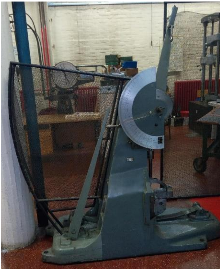
Slika 15. Charpyev bat na Fakultetu strojarstva i brodogradnje u Zagrebu
