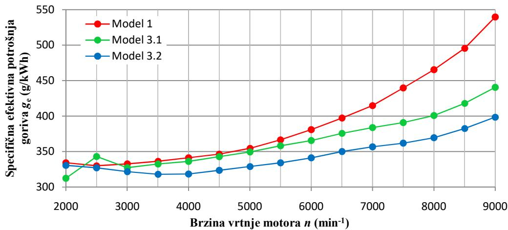
Slika 32. Specifična efektivna потрошња горива у оvisnosti о брзини вртње мотора за Model 1, Model 3.1 и Model 3.2 при djelomičnom opterećenju
