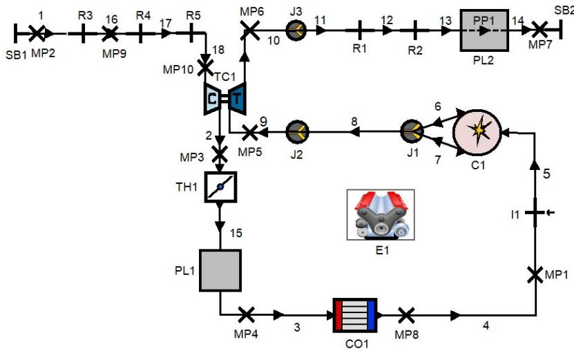
**Slika 10.** Proračunski model bolida FSB-RT05 „Strix“ s pojednostavljenim modelom turbopunjaka
