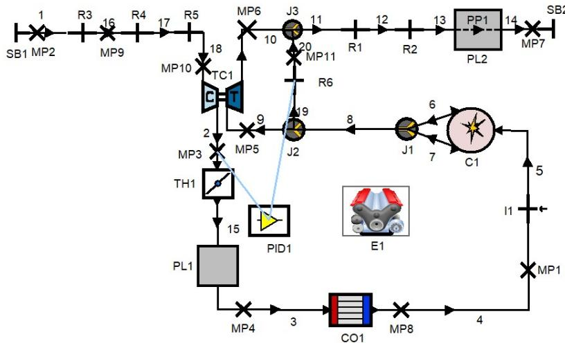
Slika 12. Proračunski model bolida FSB-RT05 „Strix“ s turbopunjačem
