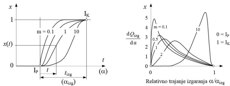
**Slika 7. Lijevo:** Udio izgorjele smjese ovisan o kutu zakreta koljenastog vratila za različite vrijednosti parametra  $m$ ; **Desno:** Udio oslobođene energije ovisan o relativnom trajanju izagranja za različite vrijednosti parametra  $m$  [1]
