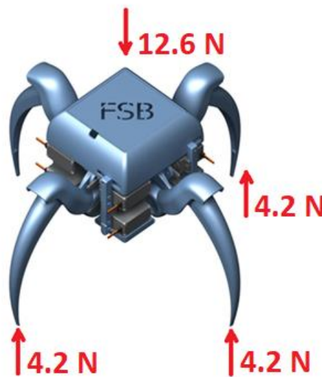
Slika 30. Suma sila koje djeluju na robota
