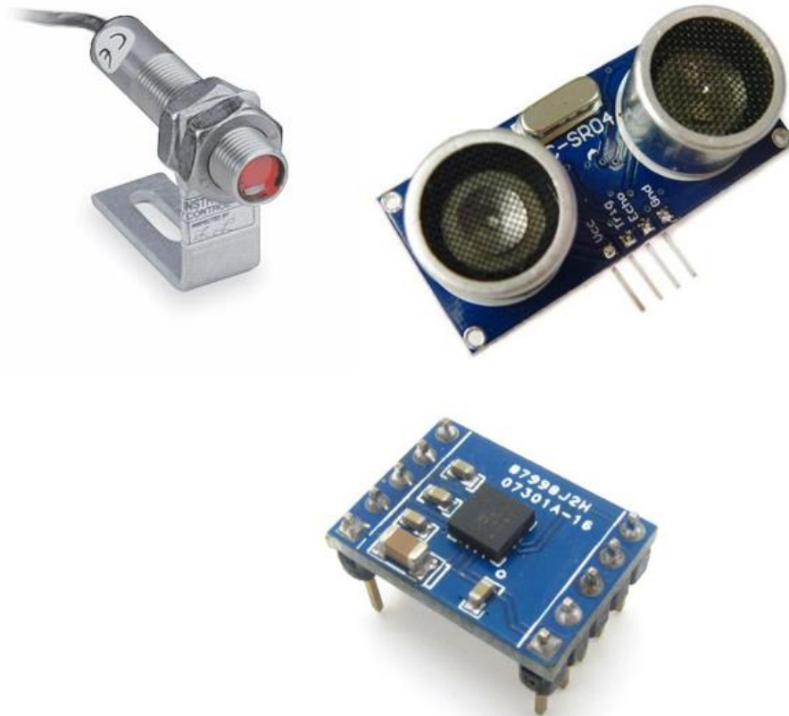
Slika 4. Često upotrebljavani senzori u mobilnoj robotici
