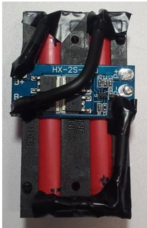
Slika 48. Serijski spojene Sanyo baterije na BMS
