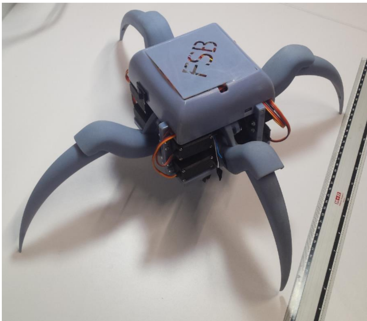
Slika 23. Fizička izvedba robota Aracne-FSB
